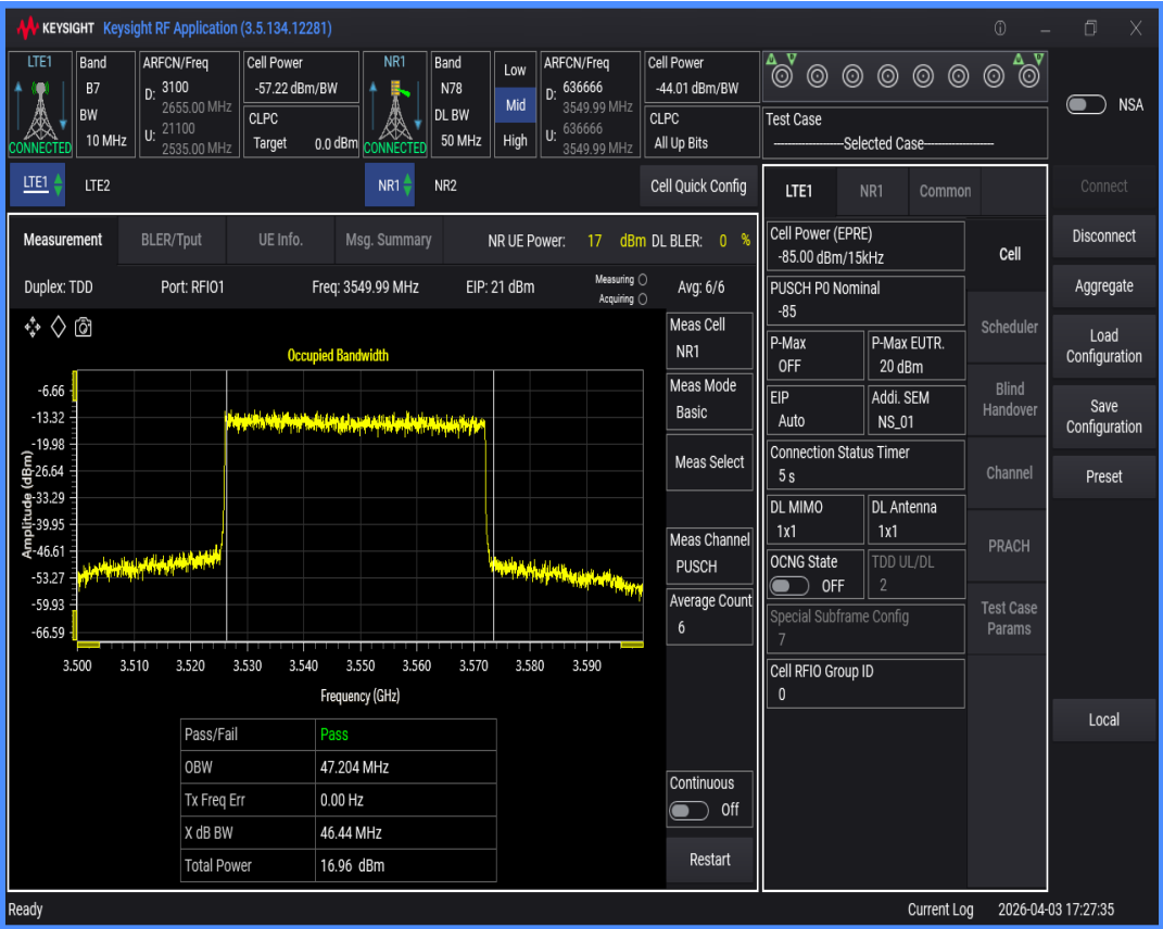
n78 SCS=30kHz DFT_QAM64 BW=20MHz Channel=636666 RB=50@0
