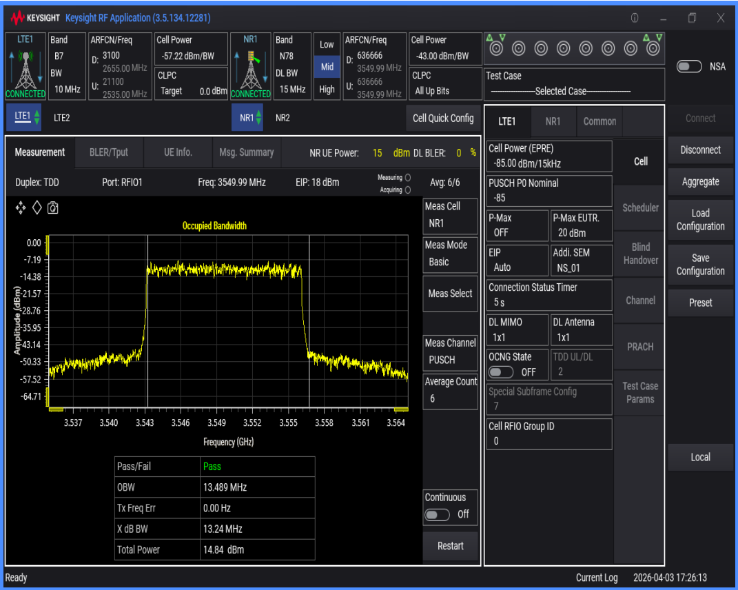
n78 SCS=30kHz DFT_QAM256 BW=20MHz Channel=636666 RB=50@0
