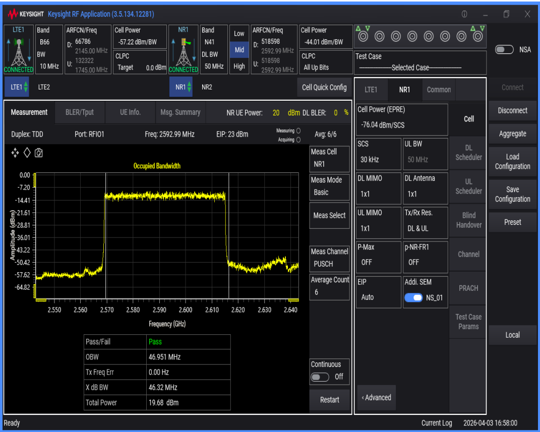
n41 SCS=30kHz DFT_BPSK BW=40MHz Channel=518598 RB=100@0
