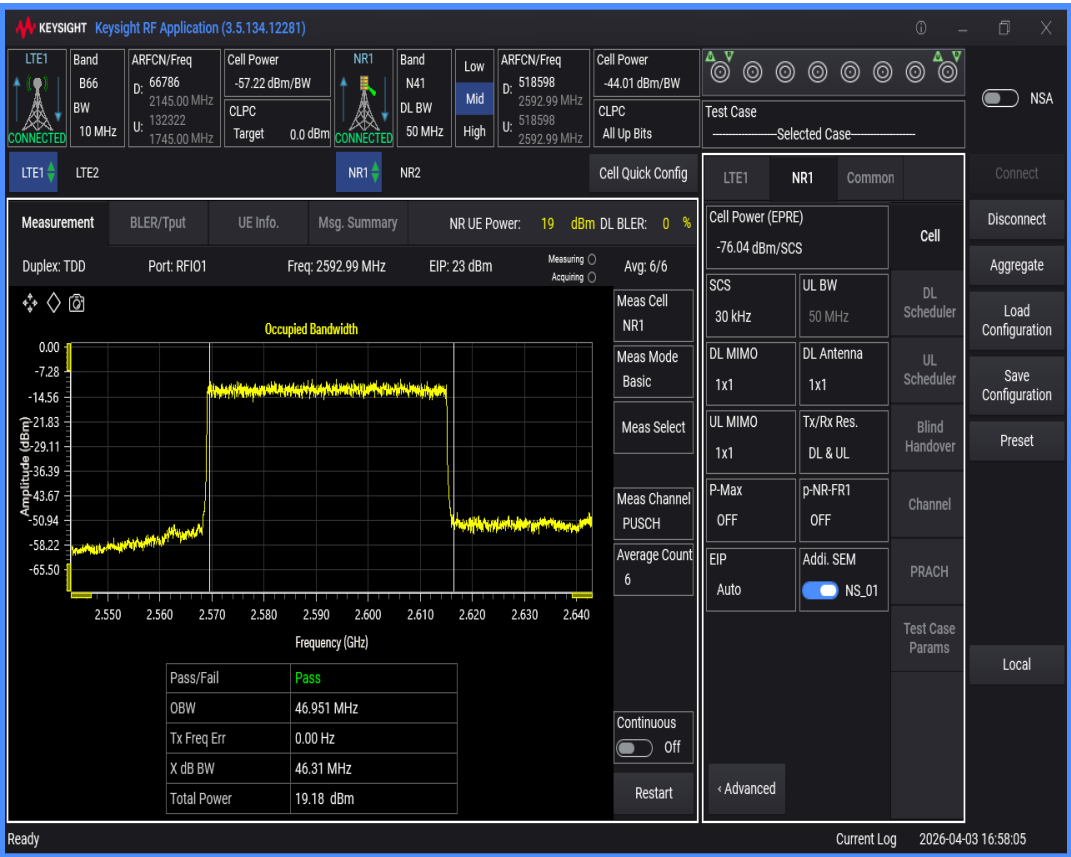
n41 SCS=30kHz DFT_QPSK BW=20MHz Channel=518598 RB=50@0
