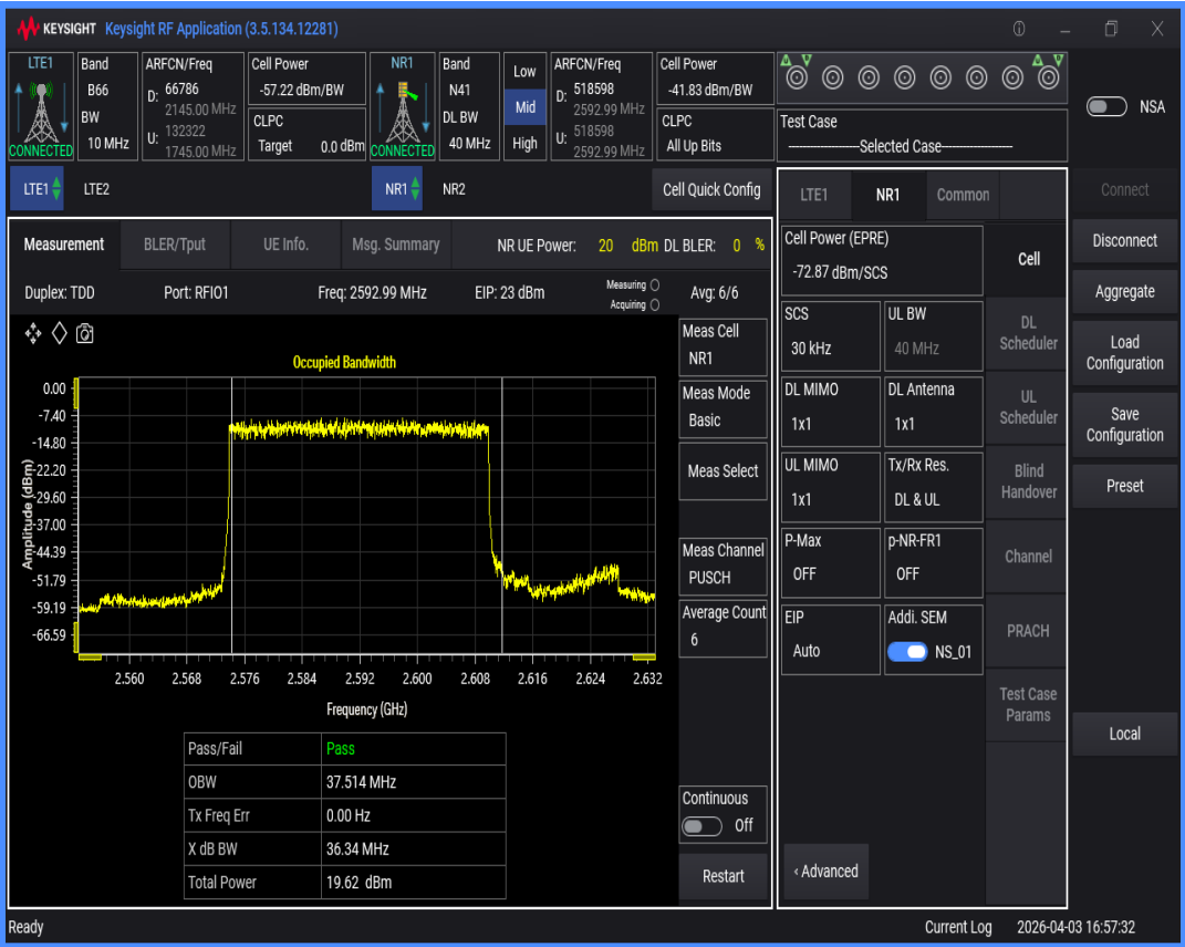
n41 SCS=30kHz DFT_BPSK BW=20MHz Channel=518598 RB=50@0
