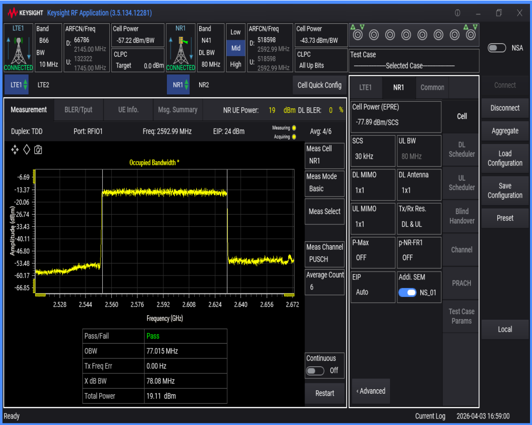
n41 SCS=30kHz DFT_QPSK BW=50MHz Channel=518598 RB=128@0
