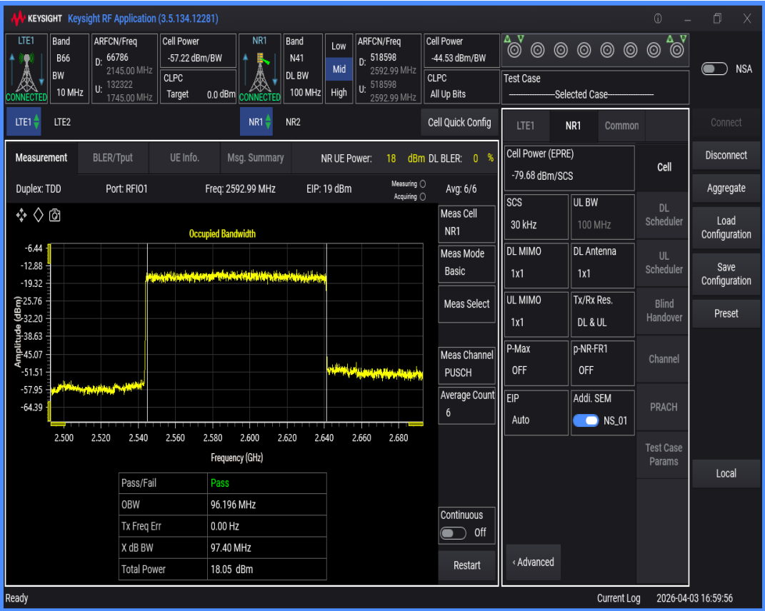
n41 SCS=30kHz DFT_QAM16 BW=20MHz Channel=518598 RB=50@0
