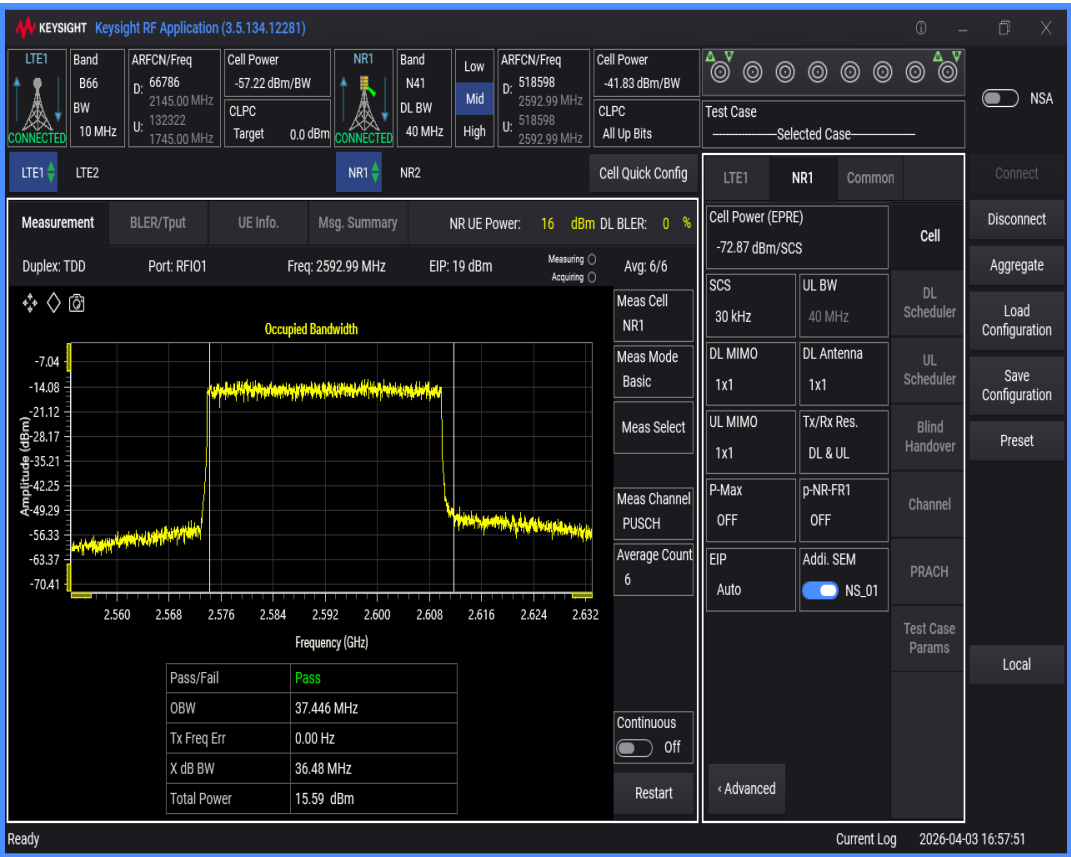
n41 SCS=30kHz DFT_QAM64 BW=20MHz Channel=518598 RB=50@0
