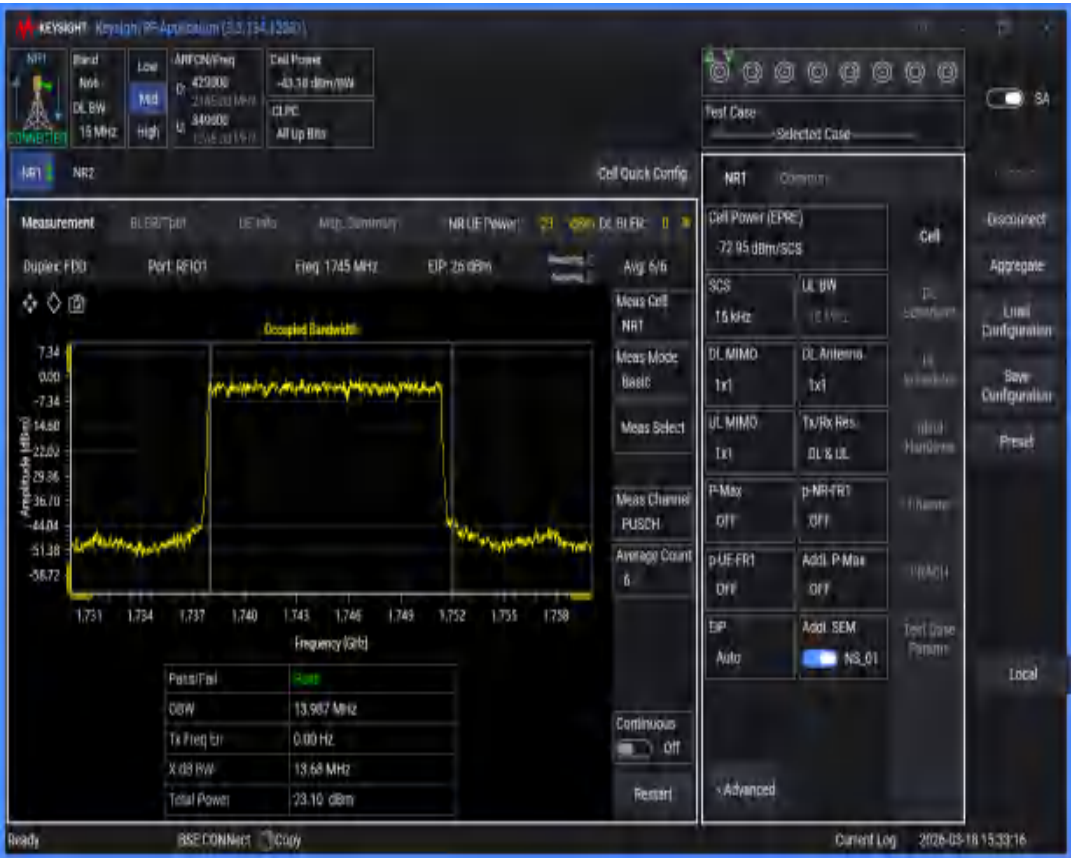
n66 SCS=15kHz DFT_QAM16 BW=10MHz Channel=349000 RB=50@0
