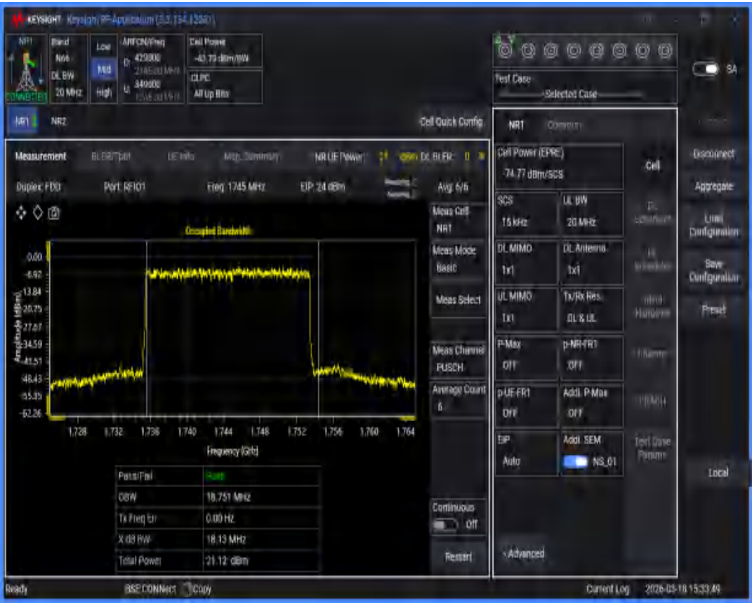
n66 SCS=15kHz DFT_QPSK BW=20MHz Channel=349000 RB=100@0
