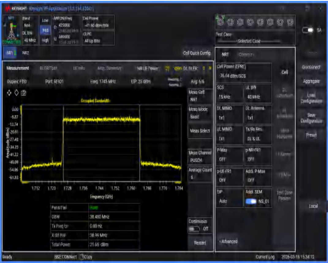
n66 SCS=15kHz DFT_QAM256 BW=10MHz Channel=349000 RB=50@0
