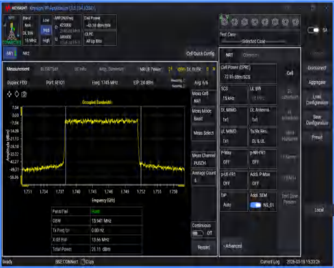
n66 SCS=15kHz DFT_QAM64 BW=10MHz Channel=349000 RB=50@0
