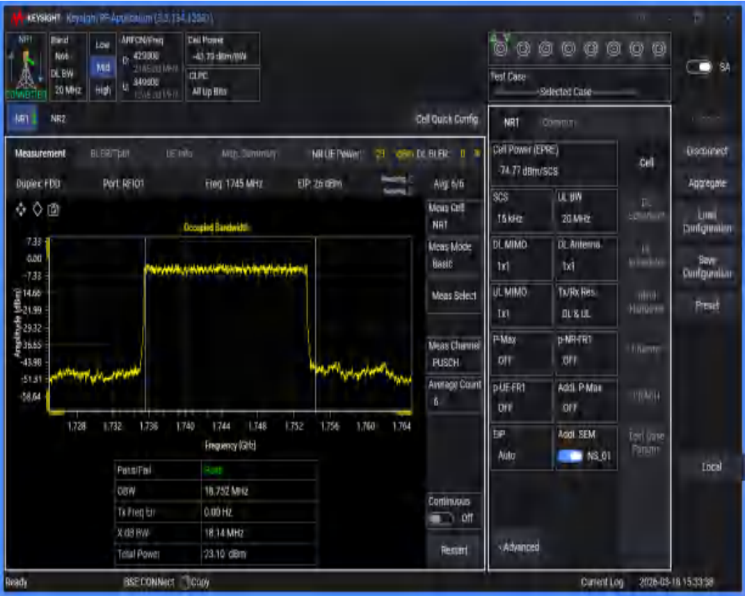
n66 SCS=15kHz DFT_BPSK BW=15MHz Channel=349000 RB=75@0
