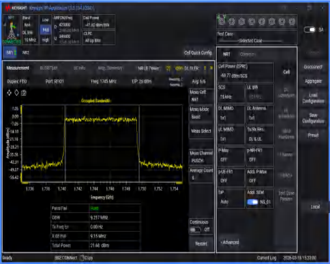
n66 SCS=15kHz DFT_BPSK BW=5MHz Channel=349000 RB=25@0
