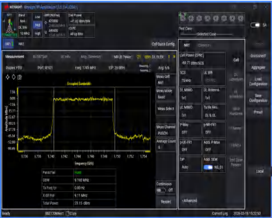
n66 SCS=15kHz DFT_BPSK BW=20MHz Channel=349000 RB=100@0
