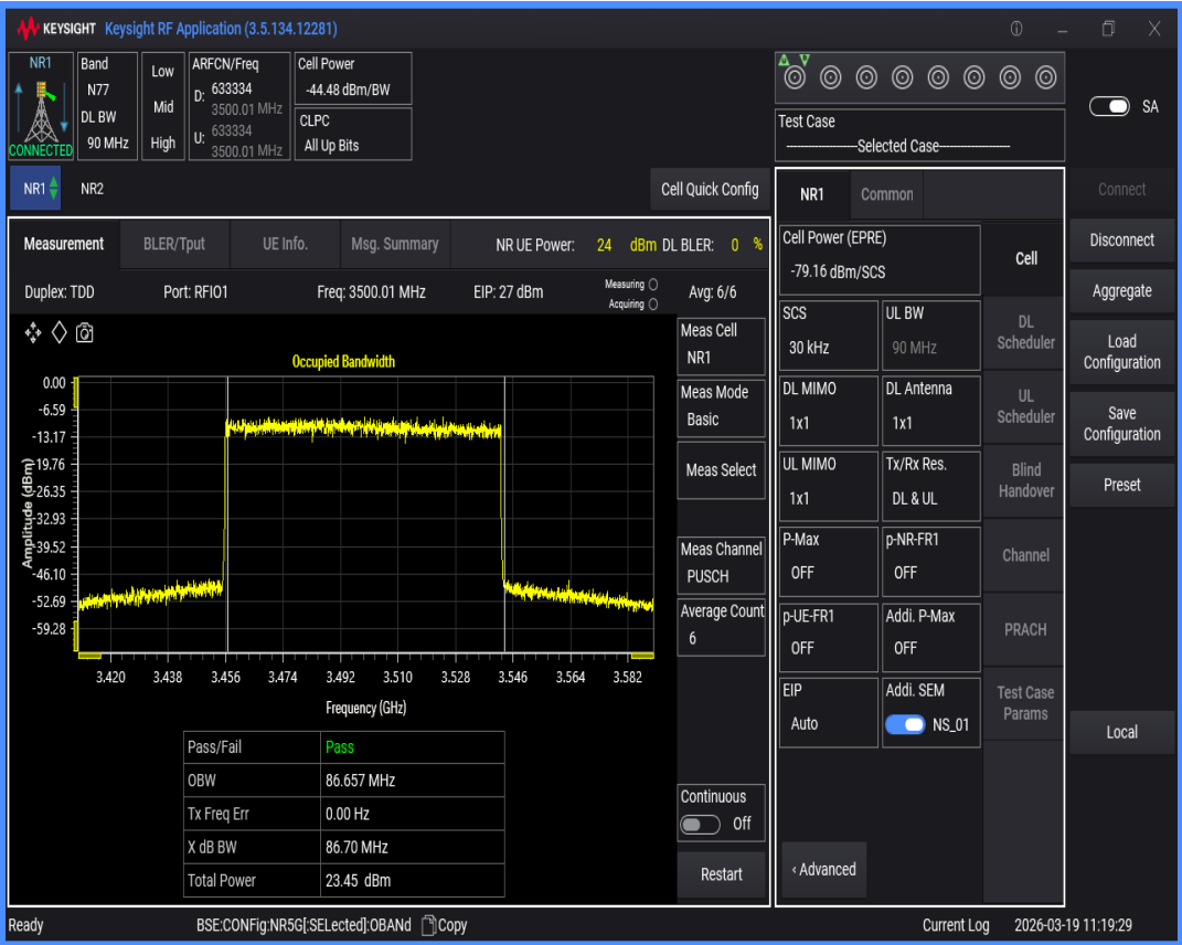
n77(3450-3550) SCS=30kHz DFT_QPSK BW=20MHz Channel=633334 RB=50@0
