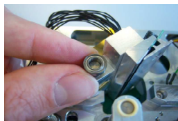
Rillenkugellager entnehmen remove the ball bearing
