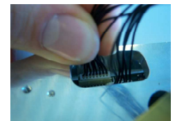
Stecker lösen und wegziehen unplug connector
