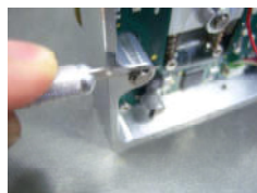
Sicherungsscheibe mit W.6 lösen remove the circlip with W.6
