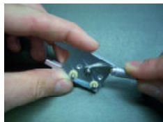
Sicherungsring mit W.3 lösen remove the circlip with W.3
