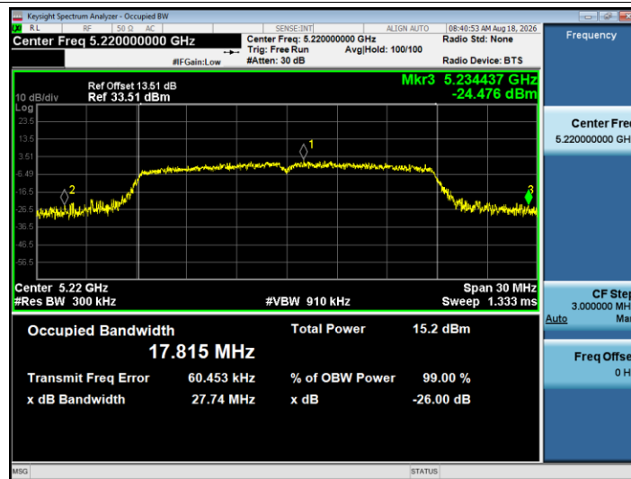
-26dB Bandwidth NVNT n20 5220MHz Ant1
