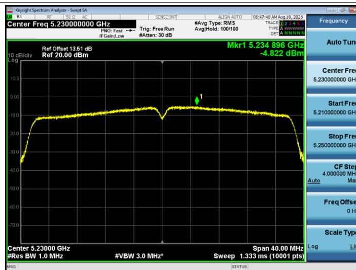
PSD NVNT n40 5230MHz Ant1
