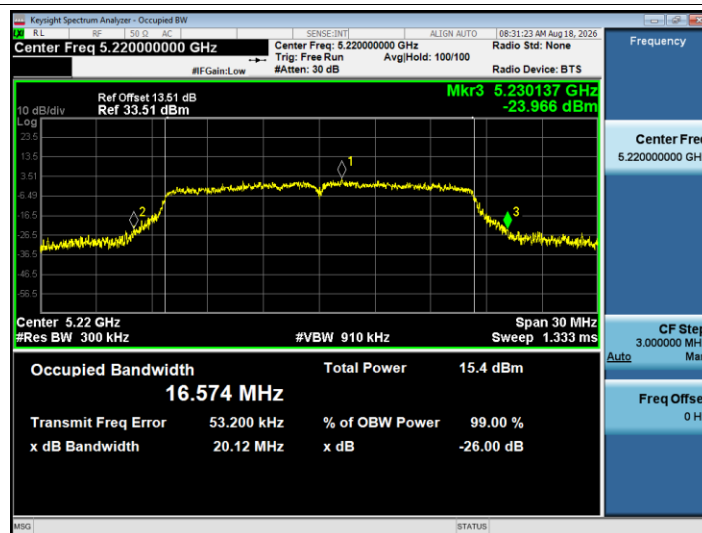
-26dB Bandwidth NVNT a 5220MHz Ant1
