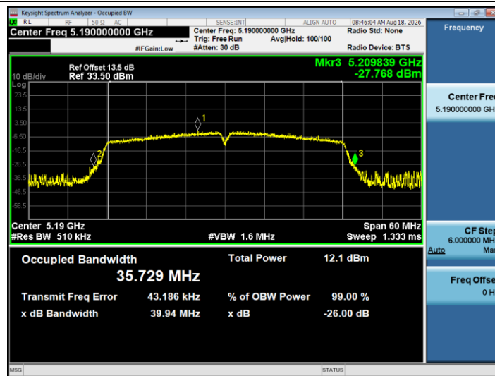
-26dB Bandwidth NVNT n40 5190MHz Ant1
