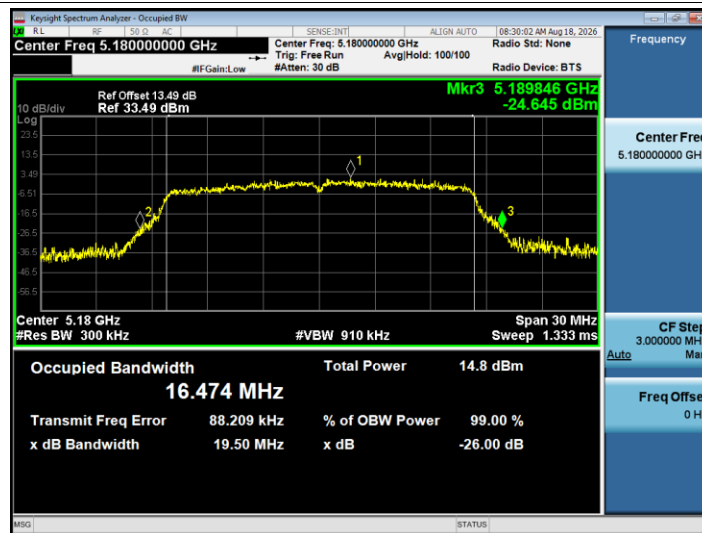
-26dB Bandwidth NVNT a 5180MHz Ant1
