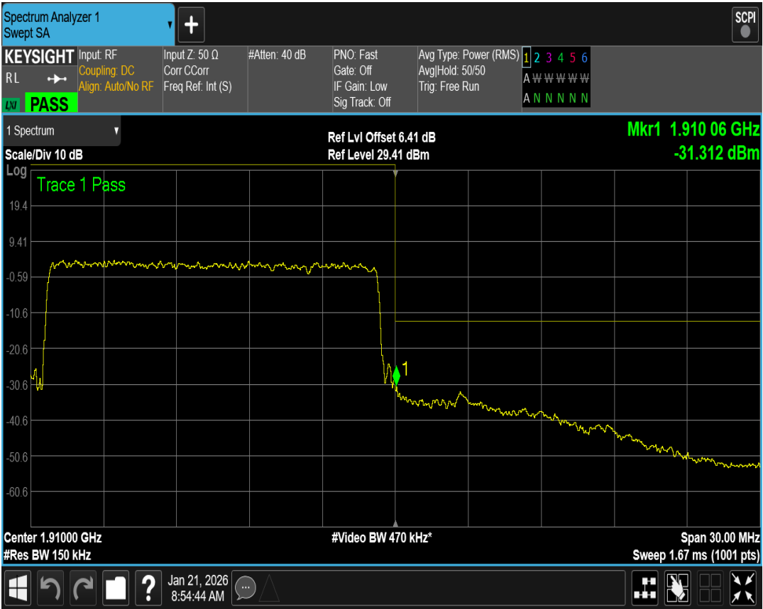
Band2 QPSK BW=20MHz Channel=18700 RB Size=100 Position=#0
