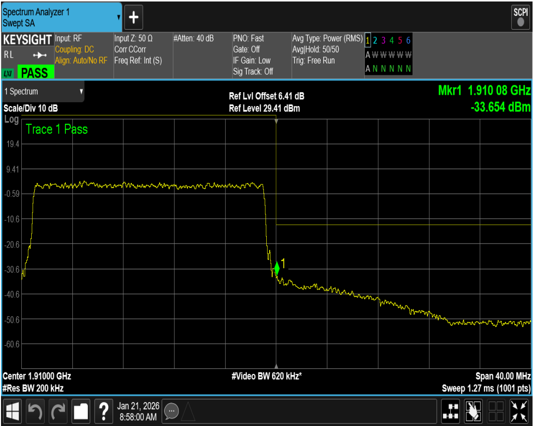
Band2 QPSK BW=20MHz Channel=19100 RB Size=100 Position=#0
