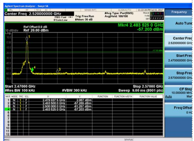
Right Band edge hopping off
