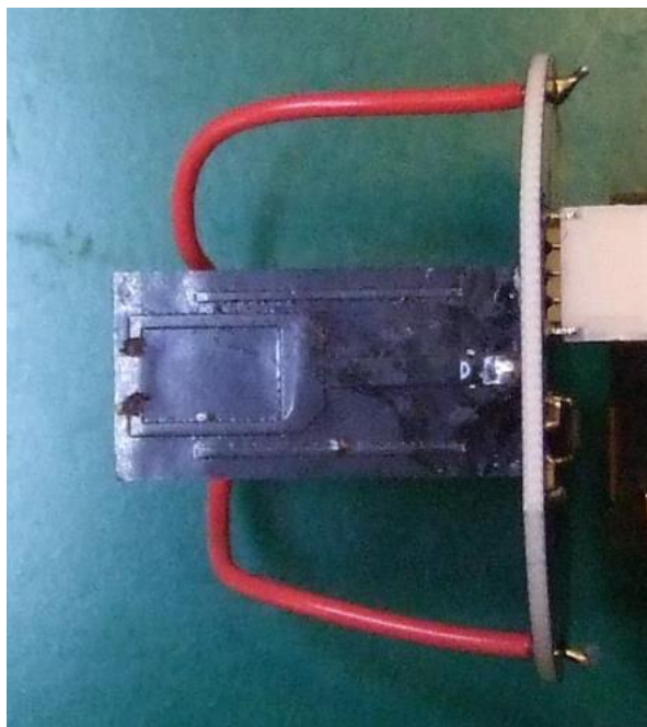
Bottom dipole antenna
