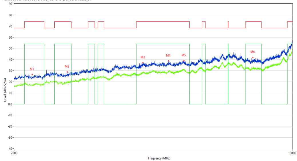
REmission Test case_FCC_Part 15E_FCC 15.407(5G)_6GHz-18GHz_B1
