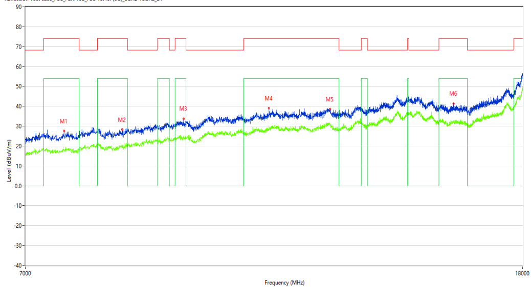
REmission Test case_FCC_Part 15E_FCC 15.407(5G)_6GHz-18GHz_B1
