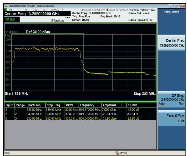
Band26(824-849)-3MHz-QPSK-27025-15RB#0-PASS
