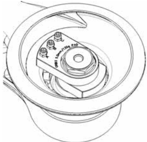
2. Configuration de la machine pour utilisation avec protecteur de plateau ou interface.
