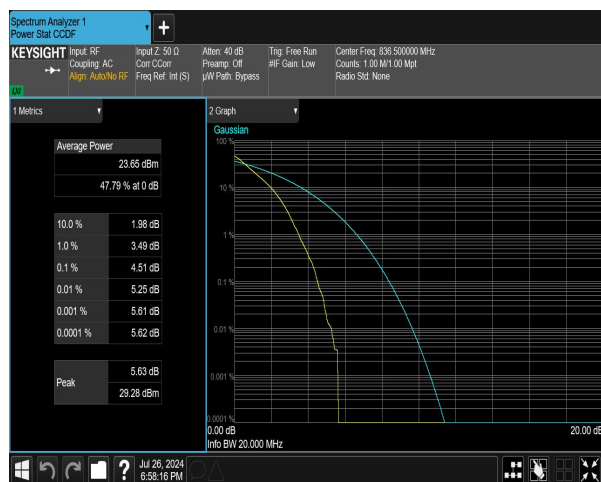
n5 SCS=15kHz DFT_BPSK BW=10MHz Channel=167300
