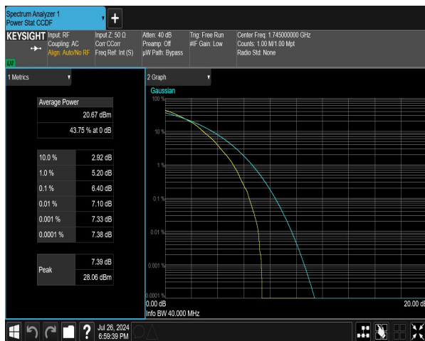
n66 SCS=15kHz DFT_64QAM BW=10MHz Channel=349000 RB=50@0 NVNT
