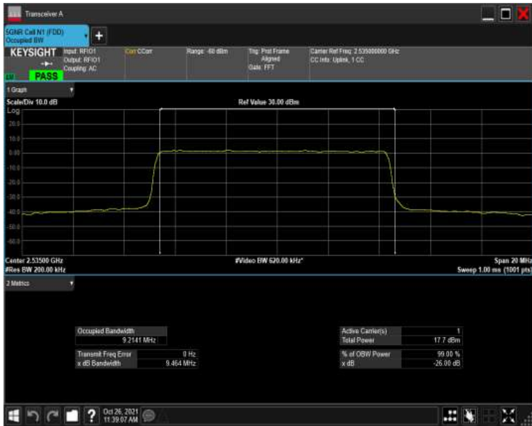
n7 SCS=15kHz DFT_QAM256 BW=10MHz Channel=513000 RB=50@0
