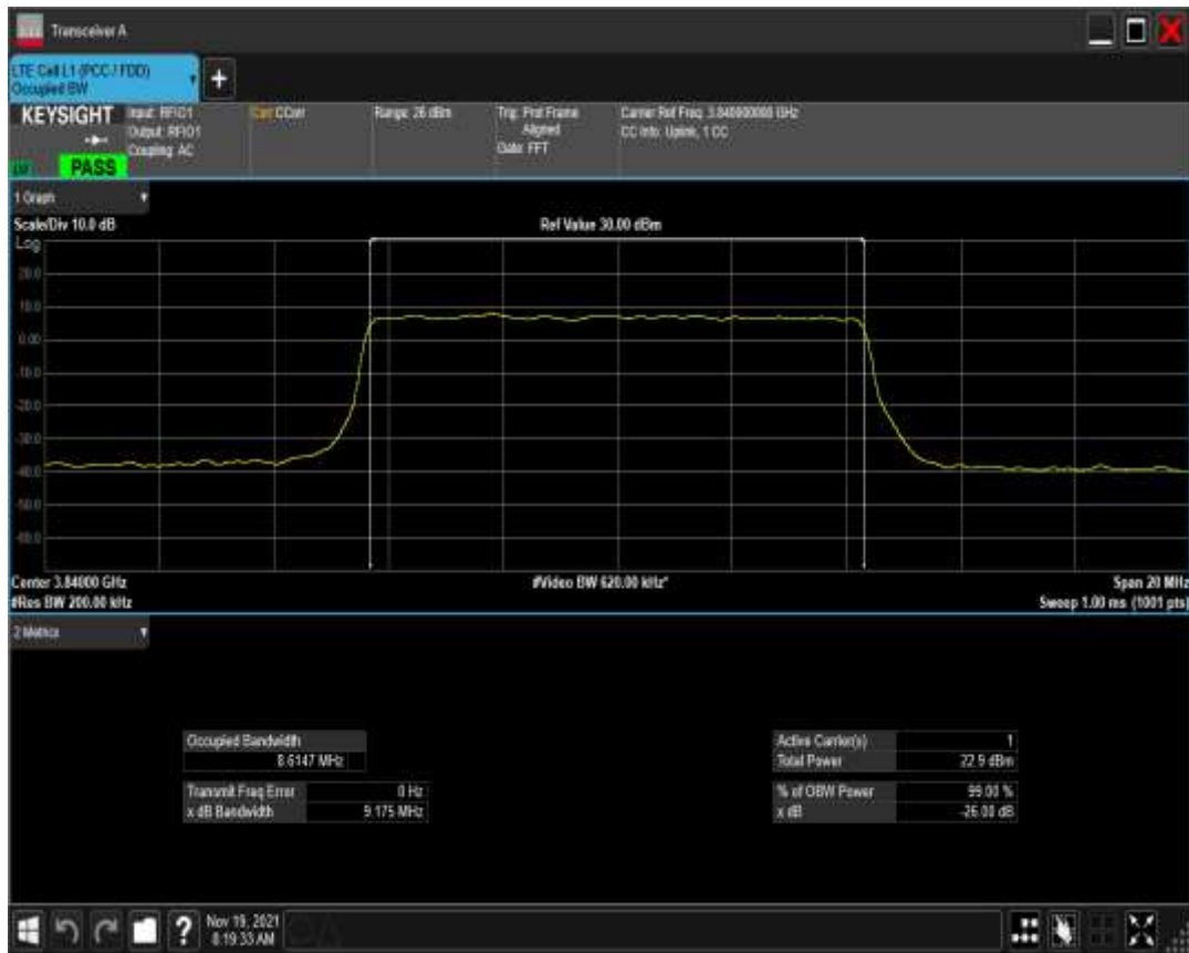
n77(3700-3980) SCS=30kHz DFT_QPSK BW=10MHz Channel=665000 RB=24@0
