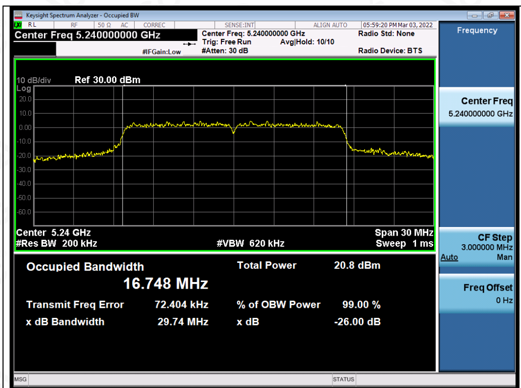
Test_Graph_802.11a_ANT1_5240_6Mbps_OBW
