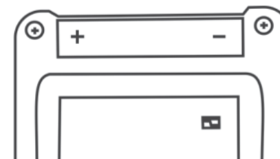
Foto 2-2: Richtung der Batterie
