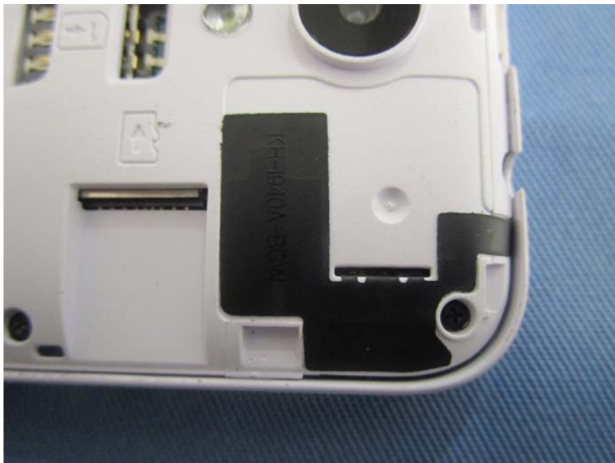
EUT –BT&WIFI&GPS Antenna View
