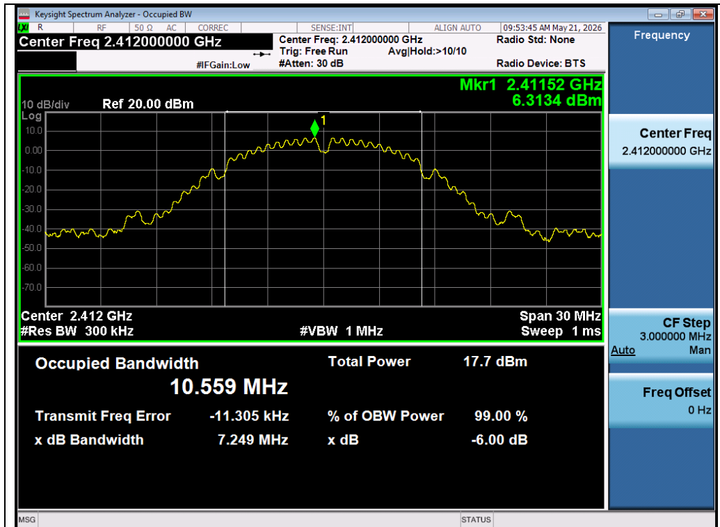
Test_Graph_802.11b_Chain A_2412_1Mbps_DTSBW
