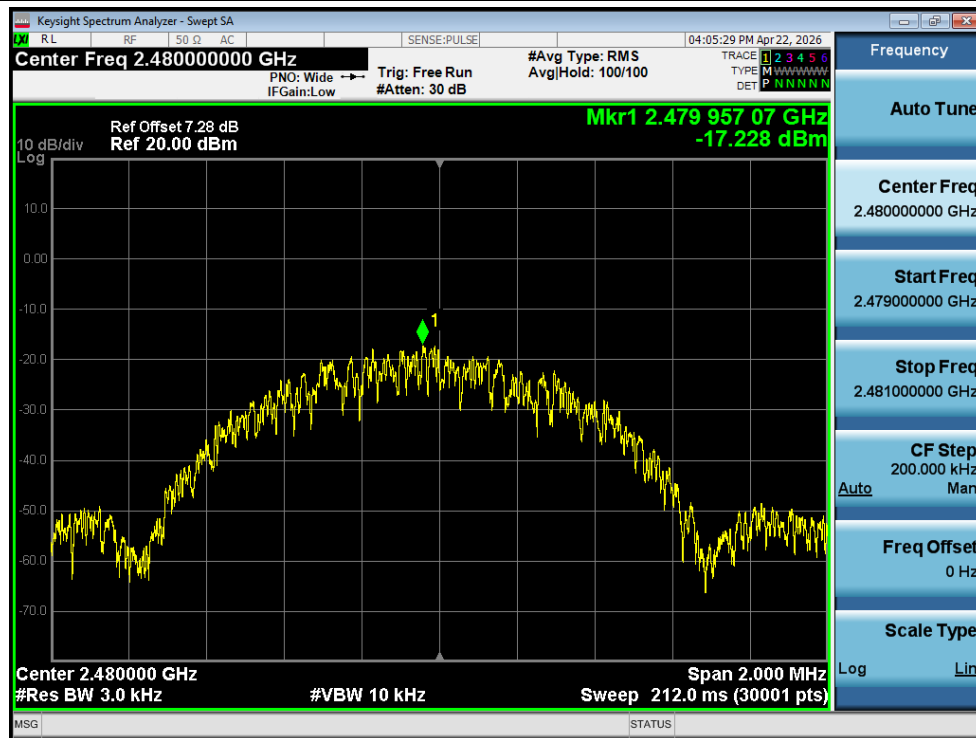
PSD NVNT BLE 1M 2480MHz Ant1
