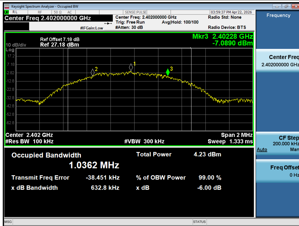
-6dB Bandwidth NVNT BLE 1M 2402MHz Ant1
