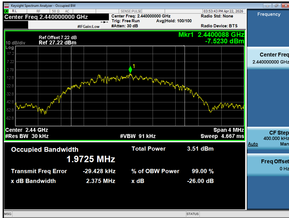
OBW NVNT BLE 2M 2440MHz Ant1
