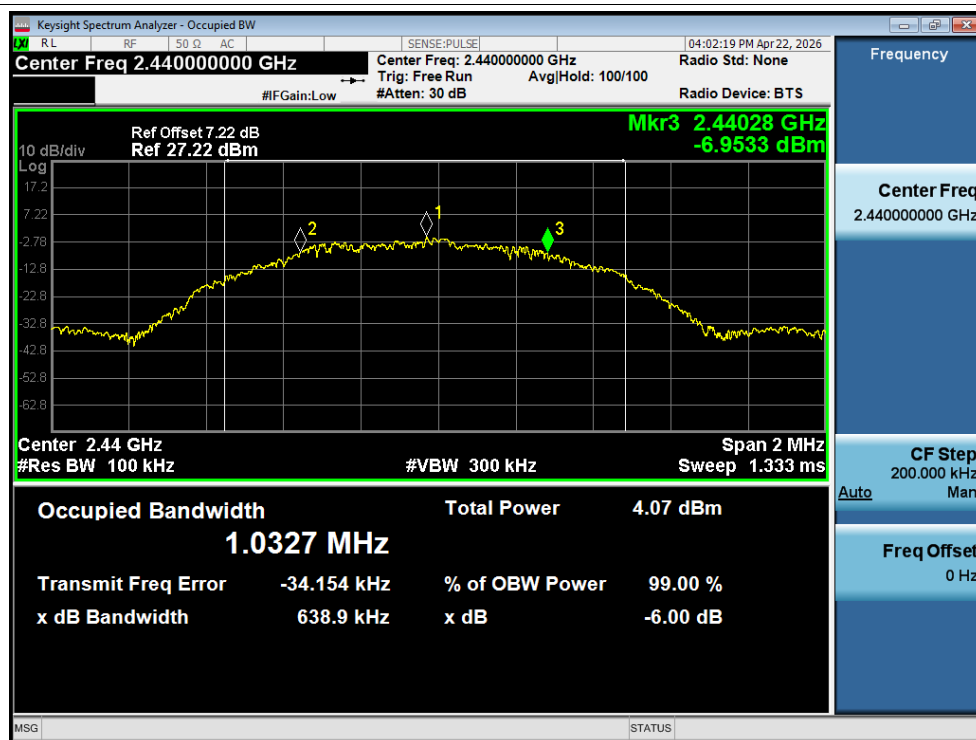
-6dB Bandwidth NVNT BLE 1M 2440MHz Ant1
