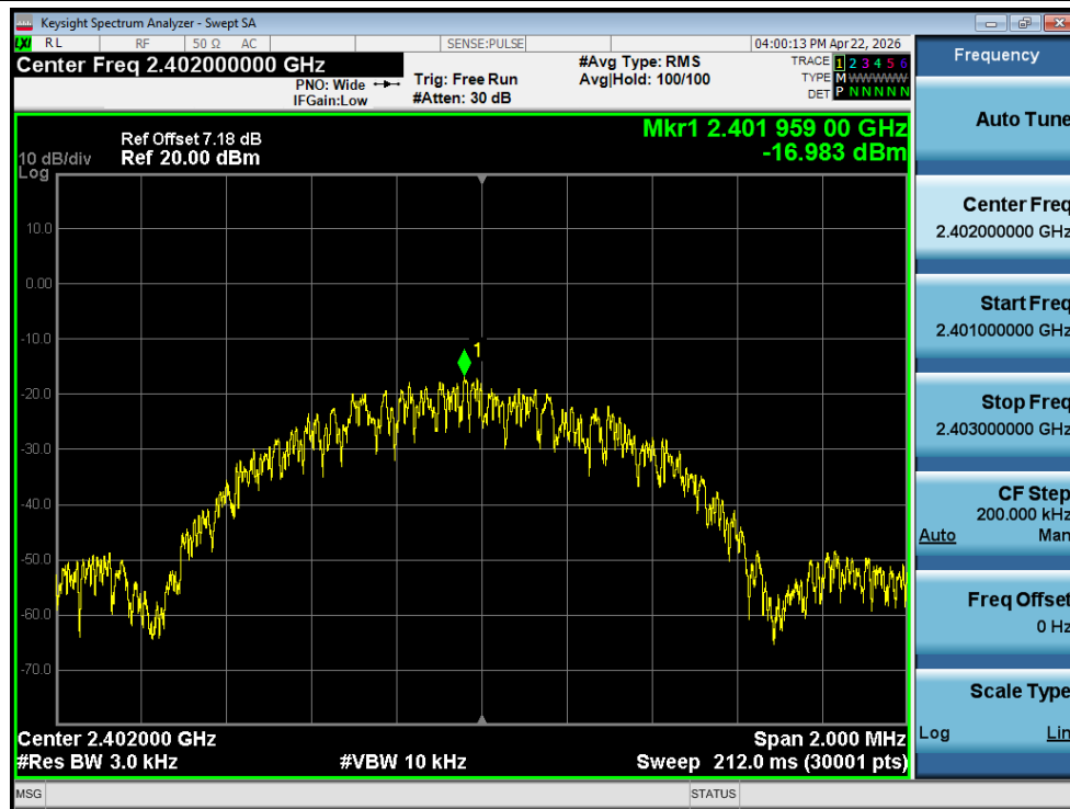
PSD NVNT BLE 1M 2402MHz Ant1
