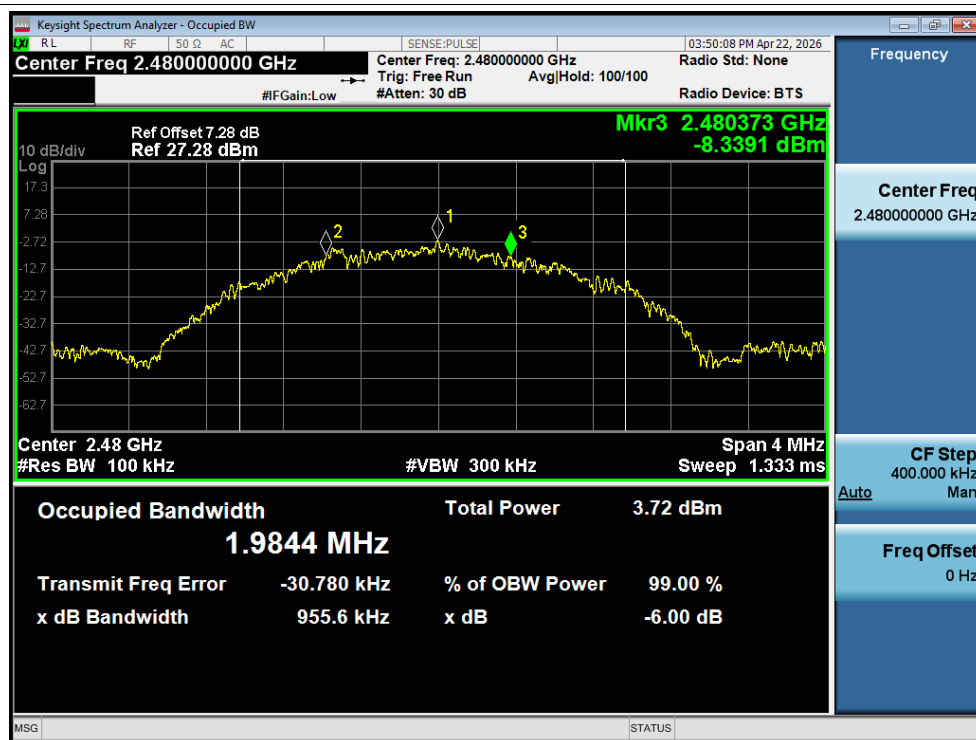
-6dB Bandwidth NVNT BLE 2M 2480MHz Ant1
