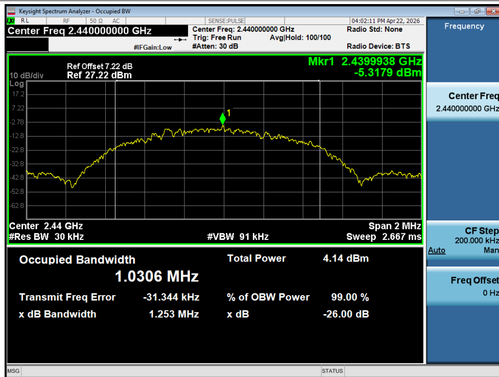
OBW NVNT BLE 1M 2440MHz Ant1
