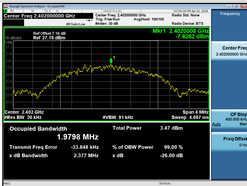
OBW NVNT BLE 2M 2402MHz Ant1
