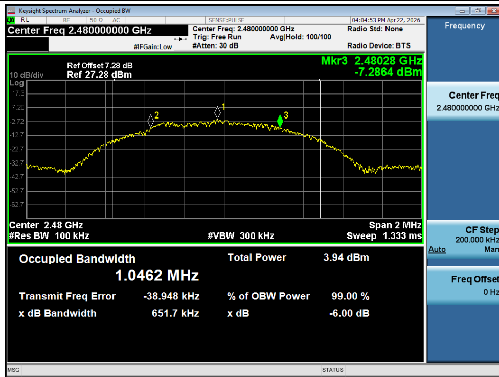
-6dB Bandwidth NVNT BLE 1M 2480MHz Ant1
