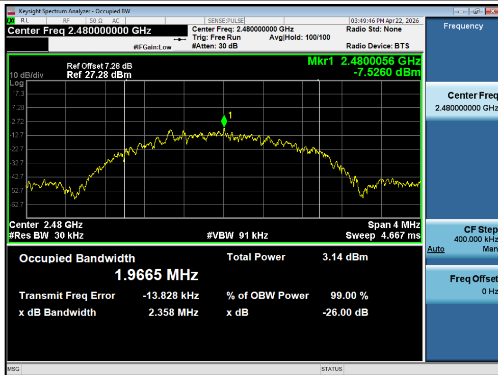
OBW NVNT BLE 2M 2480MHz Ant1
