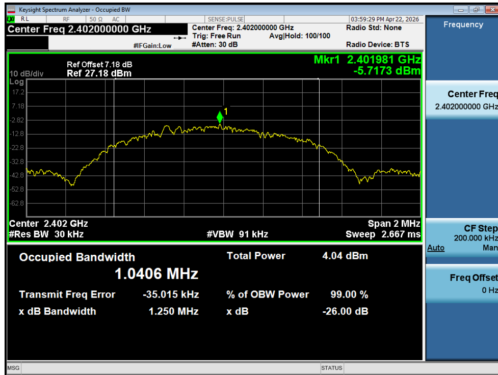
OBW NVNT BLE 1M 2402MHz Ant1
