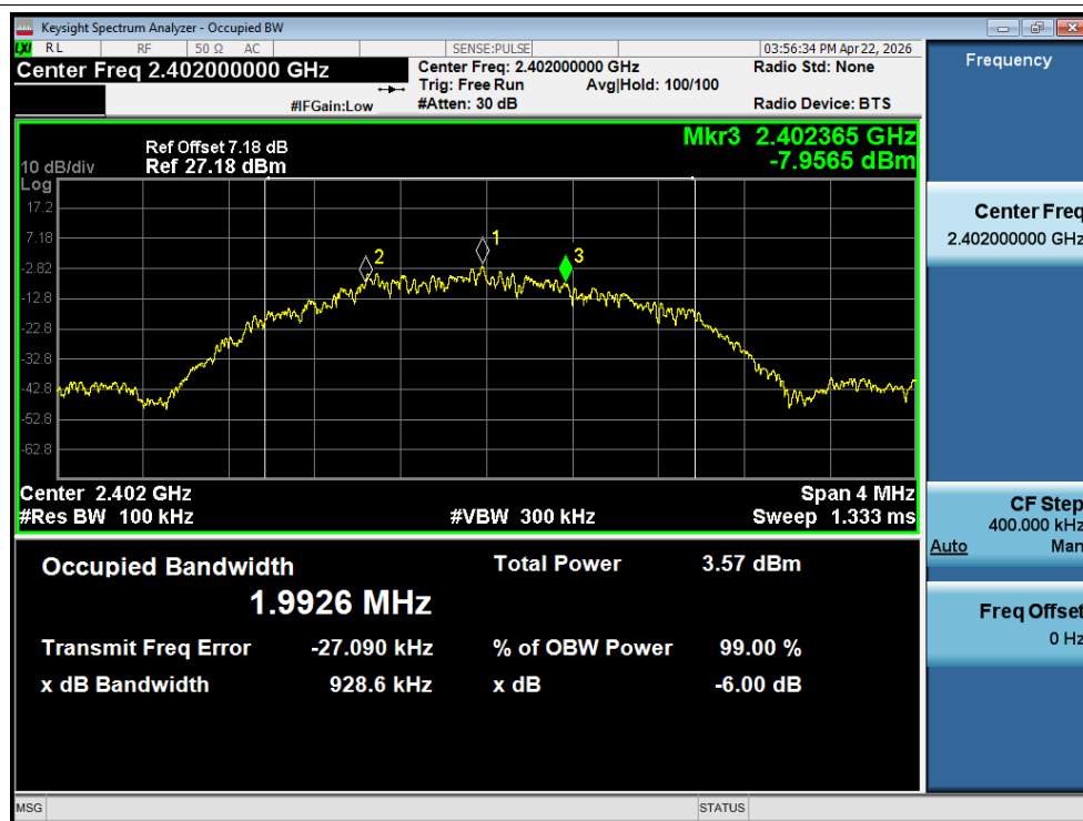
-6dB Bandwidth NVNT BLE 2M 2402MHz Ant1
