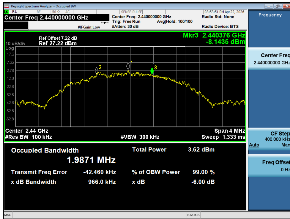
-6dB Bandwidth NVNT BLE 2M 2440MHz Ant1
