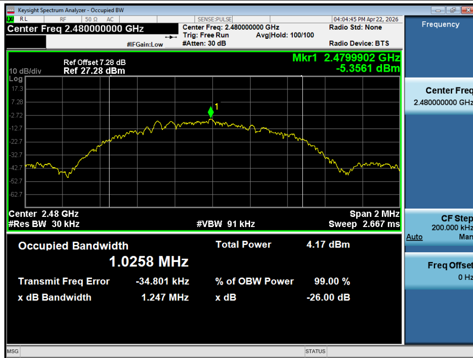
OBW NVNT BLE 1M 2480MHz Ant1
