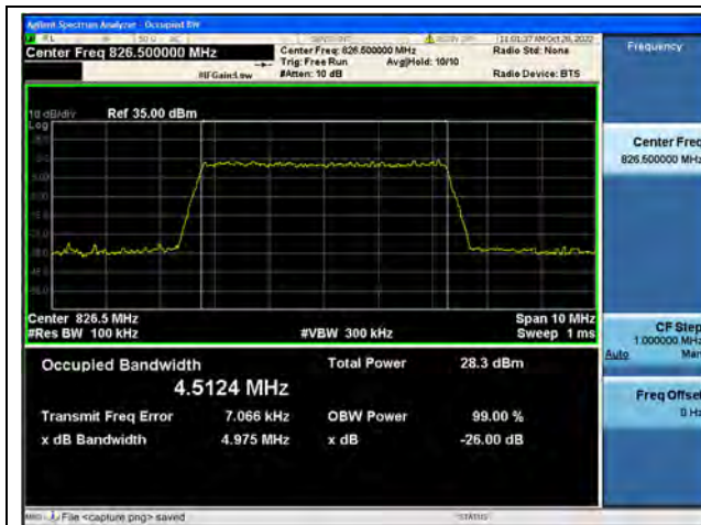
Band5 / 5MHz / QPSK/ Low CH
