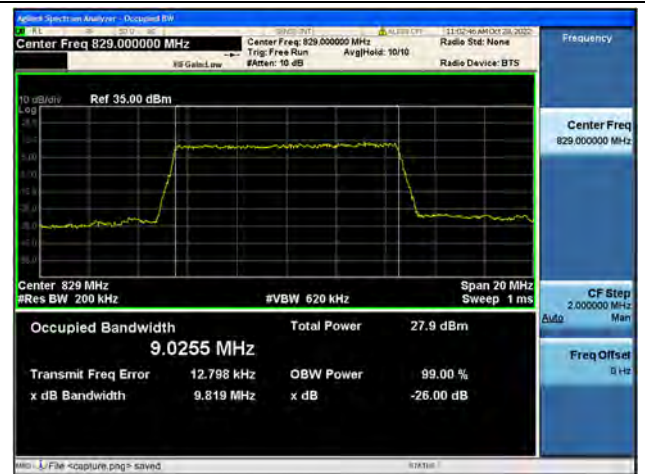
Band5 / 10MHz / QPSK/ Low CH
