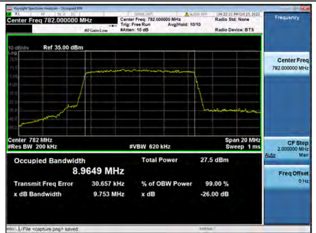
Band13 / 10MHz / QPSK/ Low CH
