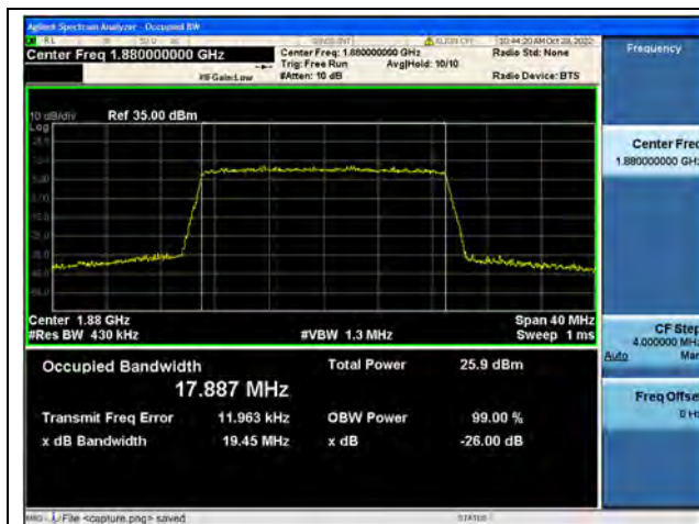
Band2 / 20MHz / QPSK/ Mid CH
