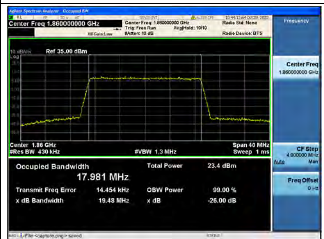
Band2 / 20MHz / 64QAM/ Low CH
