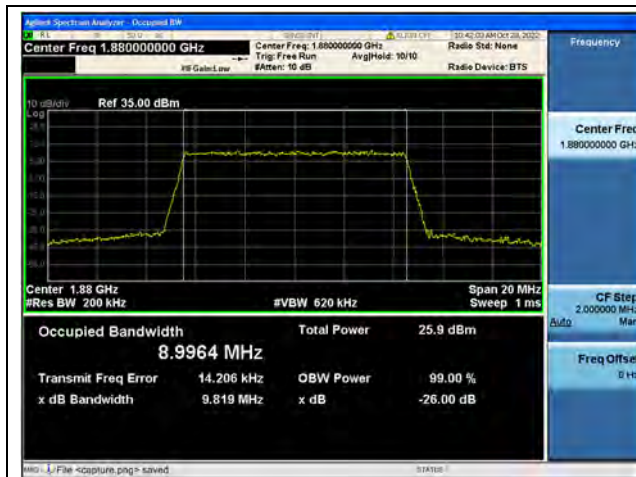
Band2 / 10MHz / QPSK/ Mid CH
