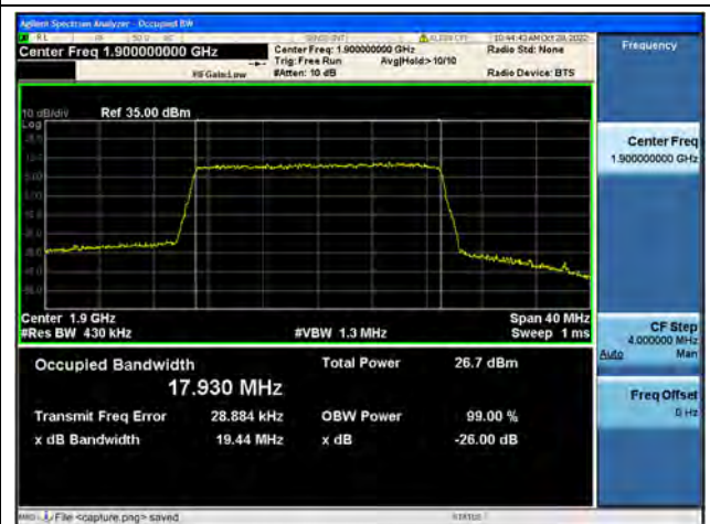
Band2 / 20MHz / QPSK/ High CH
