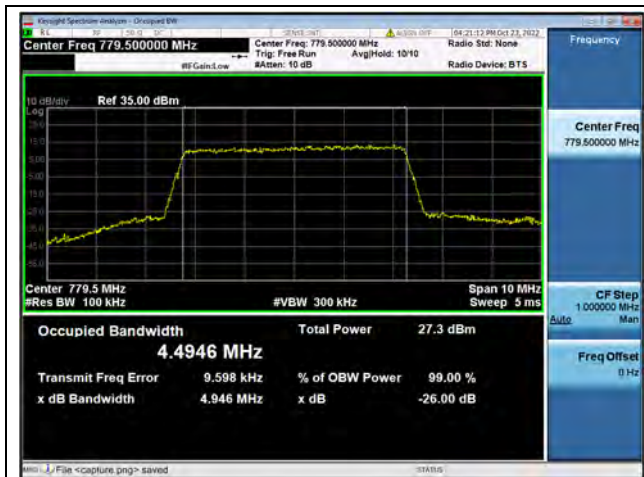
Band13 / 5MHz / QPSK/ Low CH
