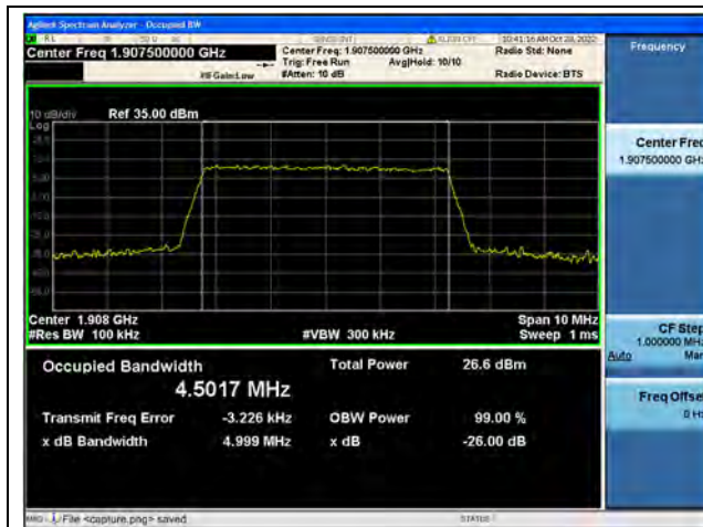
Band2 / 5MHz / QPSK/ High CH
