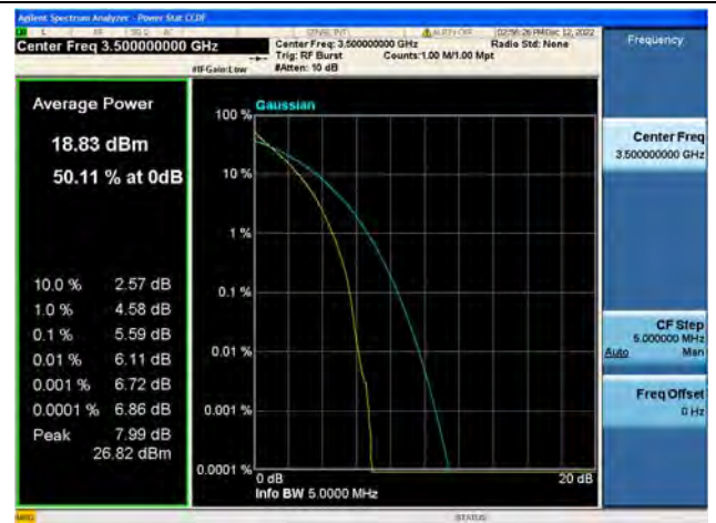
Band42(3450~3550) / 5MHz / Mid CH / QPSK
