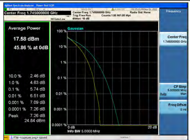
Band66 / 5MHz / Mid CH / QPSK
