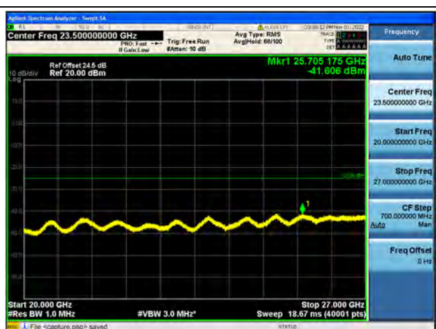
Band41-20G-27G / 15MHz / Low CH / QPSK
