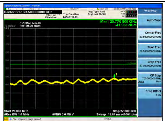
Band41-20G-27G / 5MHz / Low CH / QPSK
