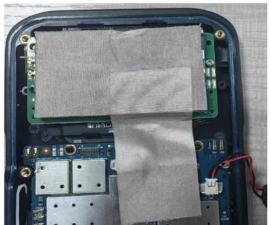
整机顶部绿色小板贴导电布与主板屏蔽罩接地
