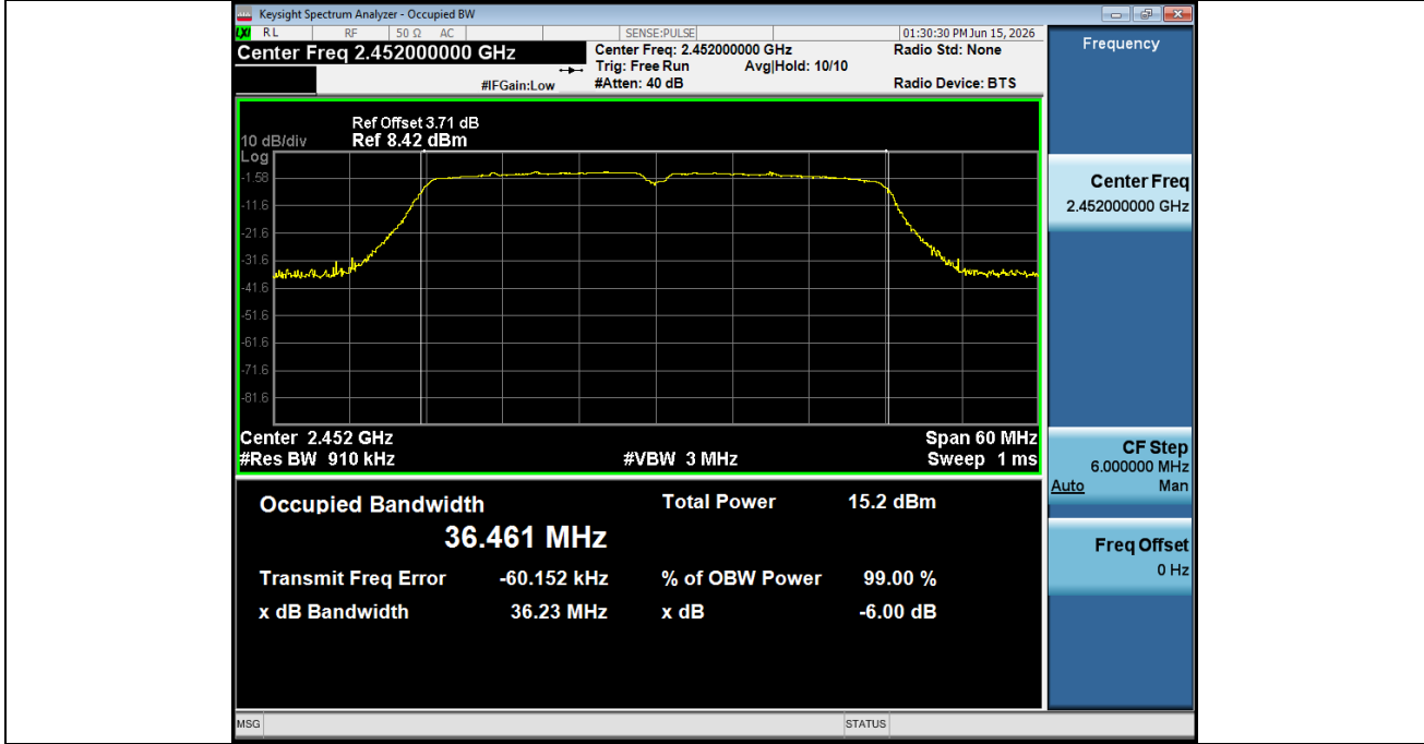
-6dB Bandwidth NVNT ANT2 802 11n(HT40) 2452
