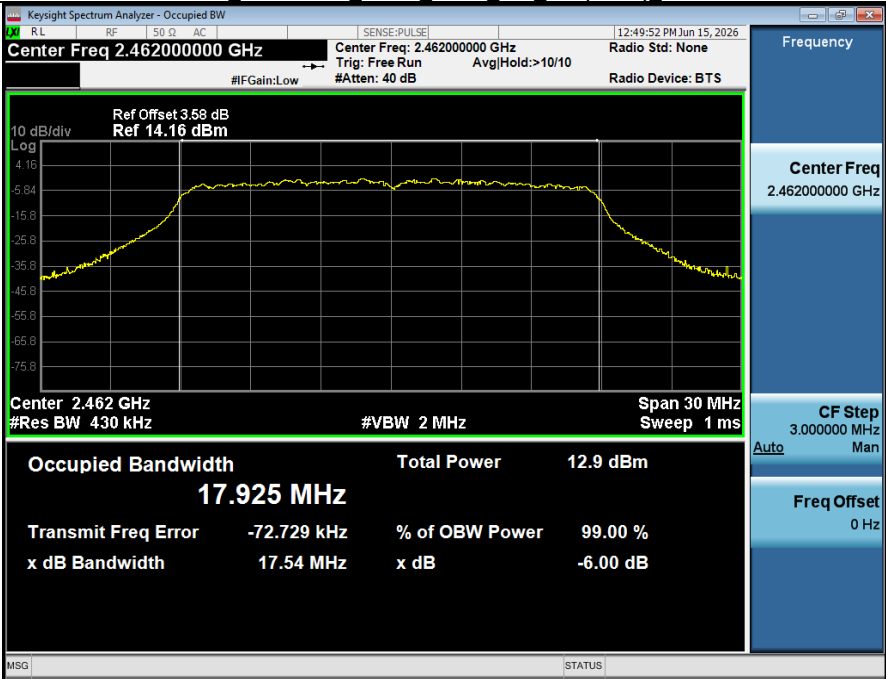
-6dB Bandwidth NVNT ANT2 802 11n(HT20) 2462
