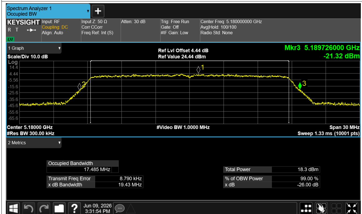
-26dB Bandwidth NVNT ac20 5200MHz Ant1
