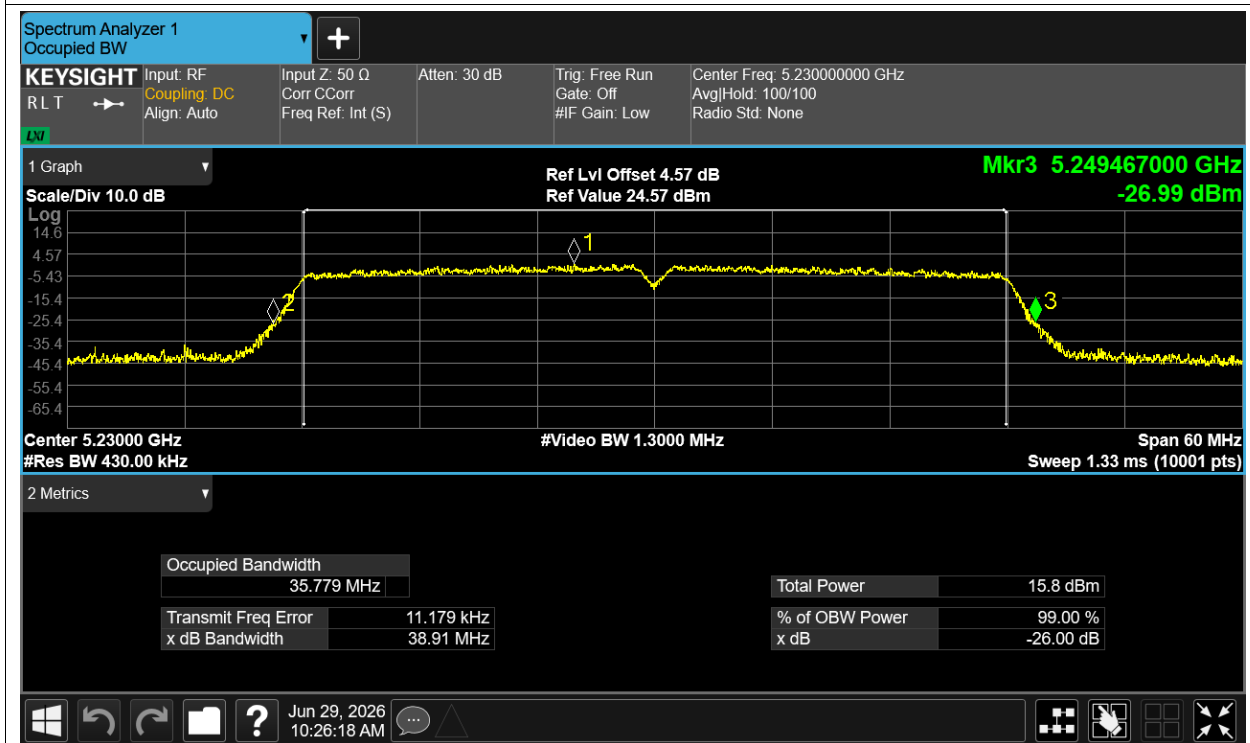
-26dB Bandwidth NVNT ac80 5210MHz Ant1
