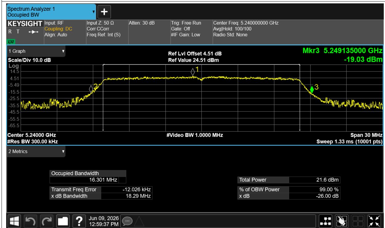
-26dB Bandwidth NVNT ac20 5180MHz Ant1
