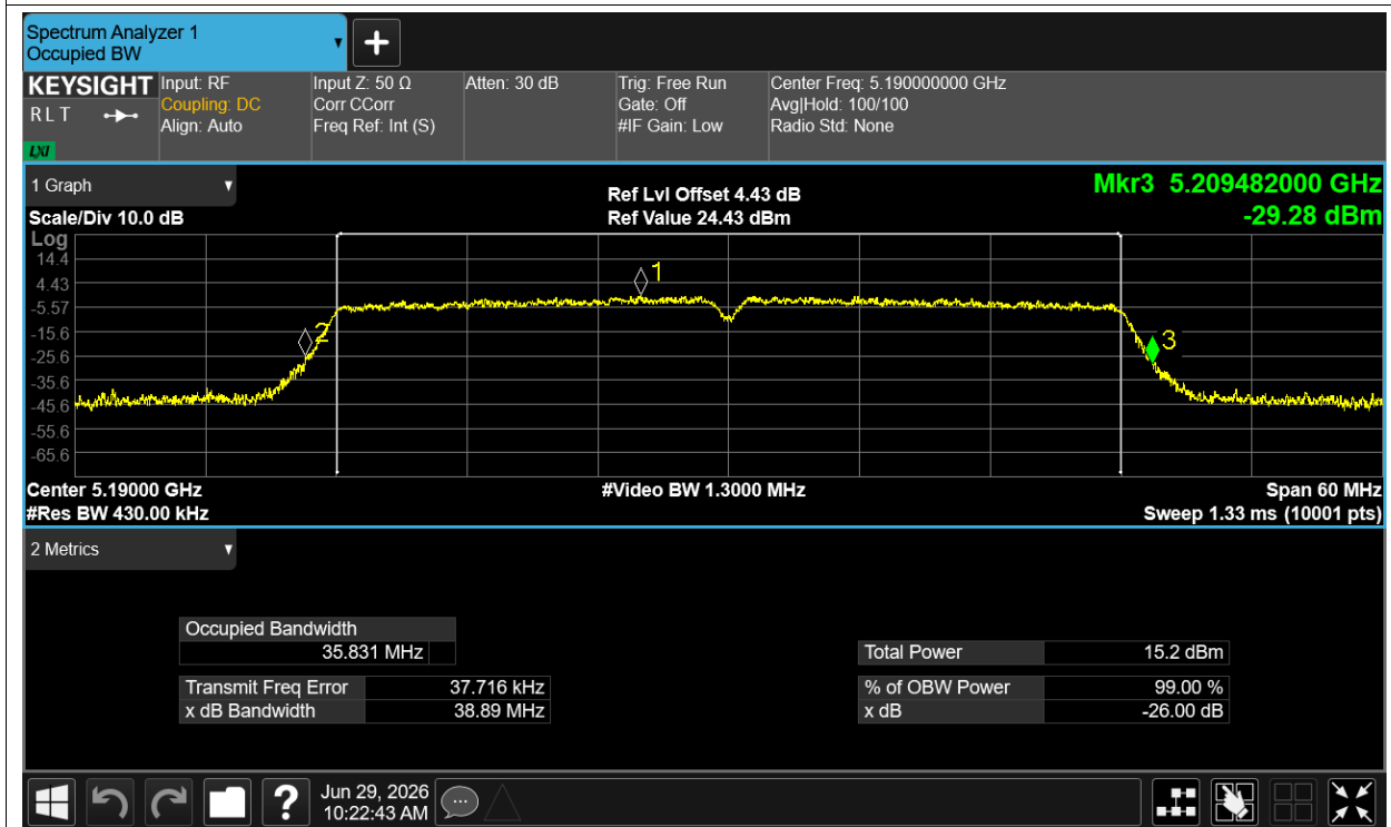
-26dB Bandwidth NVNT ac40 5230MHz Ant1
