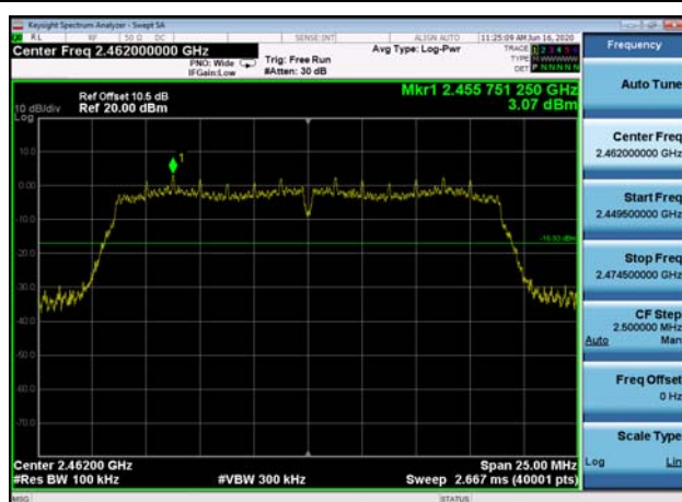
,Plot 2,Band Edge-802.11n(HT20) ,2437MHz
