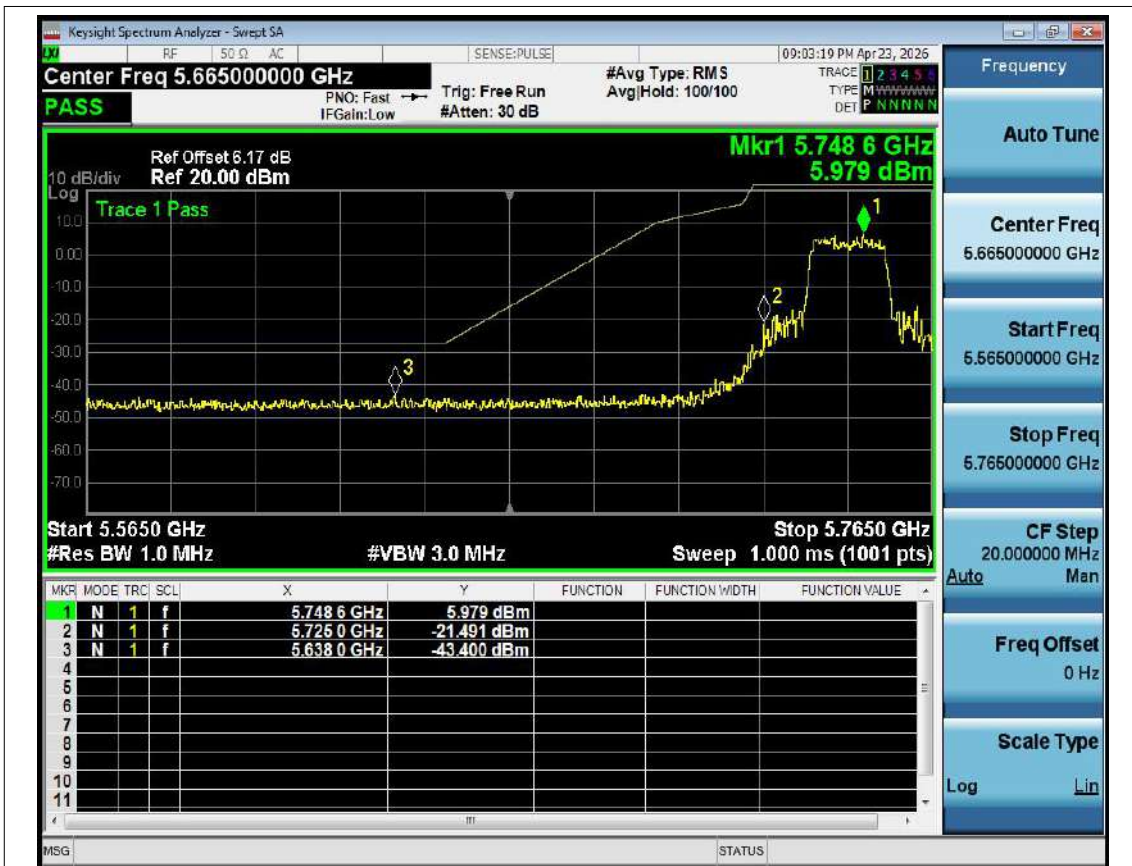
Band Edge NVNT ac20 5745MHz Low Ant1
