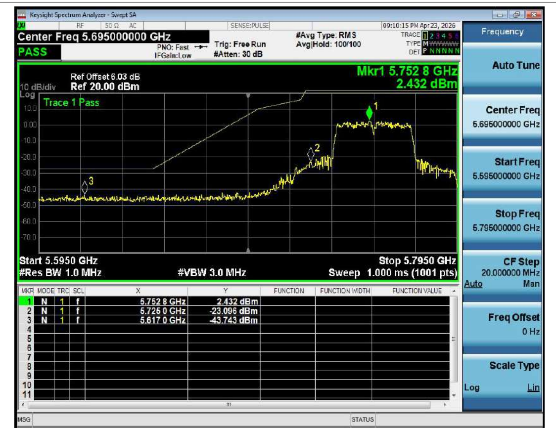
Band Edge NVNT ac40 5755MHz Low Ant1
