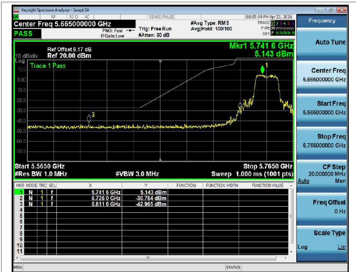
Band Edge NVNT a 5745MHz Low Ant1
