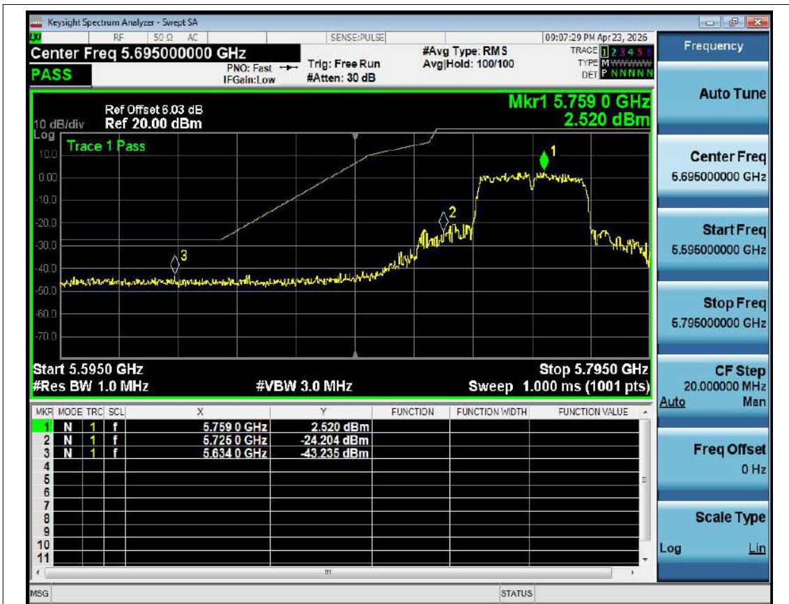
Band Edge NVNT n40 5755MHz Low Ant1
