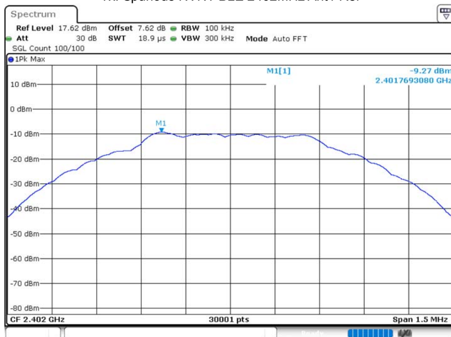
Tx. Spurious NVNT BLE 2402MHz Ant1 Ref
