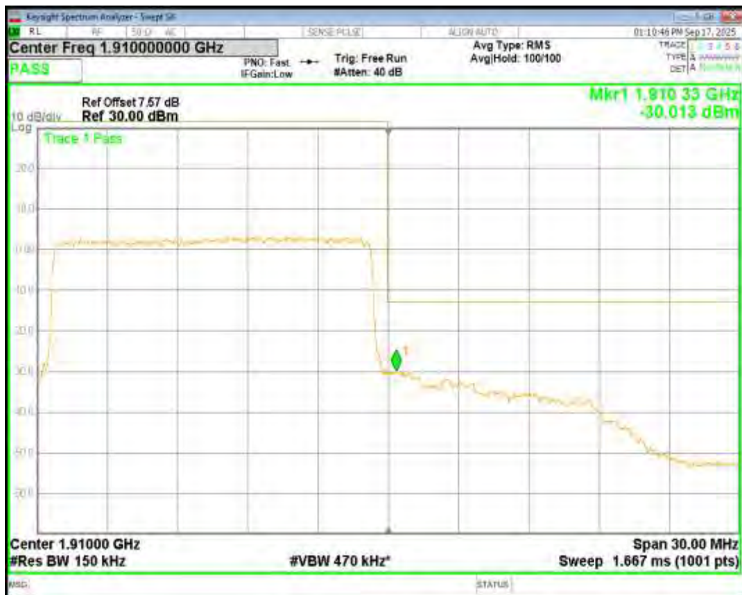
Band2 QPSK BW=20MHz Channel=18700 RB Size=100 Position=#0
