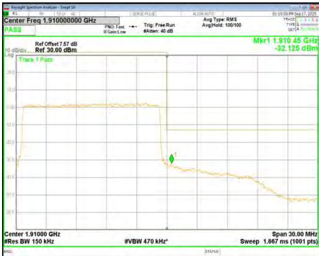
Band2 16QAM BW=20MHz Channel=18700 RB Size=100 Position=#0
