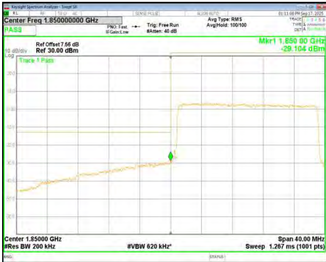
Band2 QPSK BW=20MHz Channel=19100 RB Size=100 Position=#0
