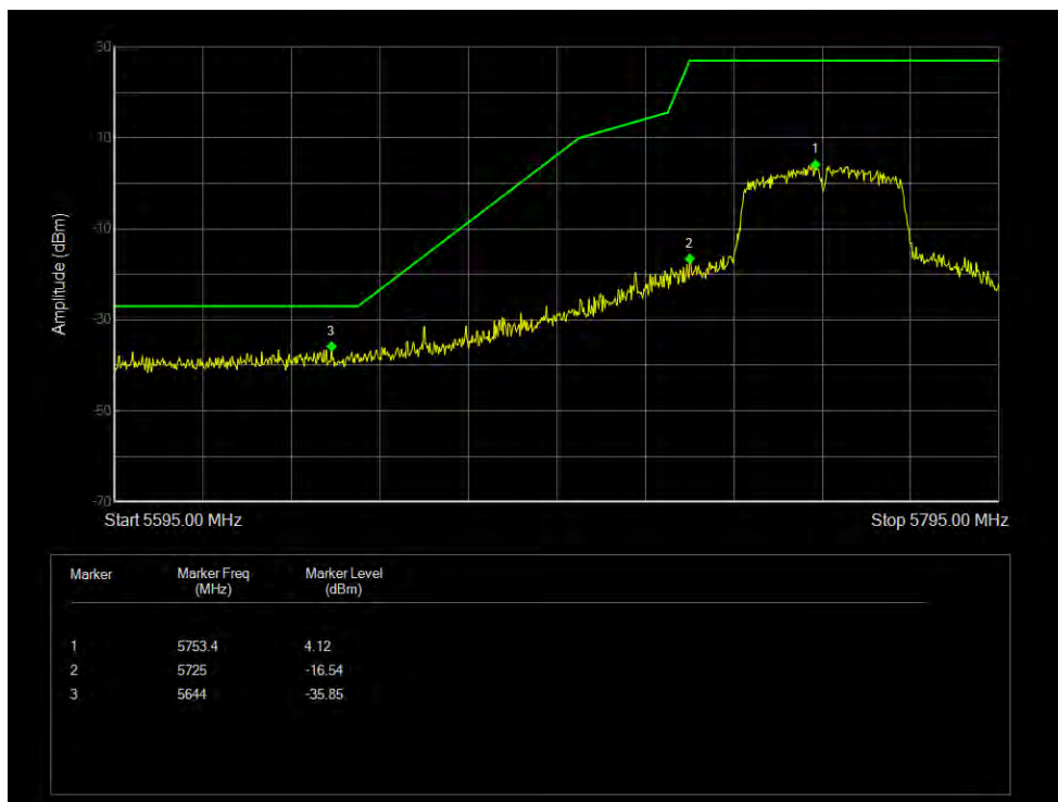
Band Edge NVNT 802.11n(HT40) 5755MHz Low Ant1
