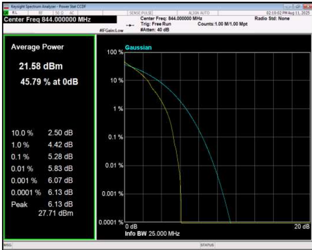
Band26(824-849) QPSK BW=15MHz Channel=26865 RB Size=1 Position=#0
