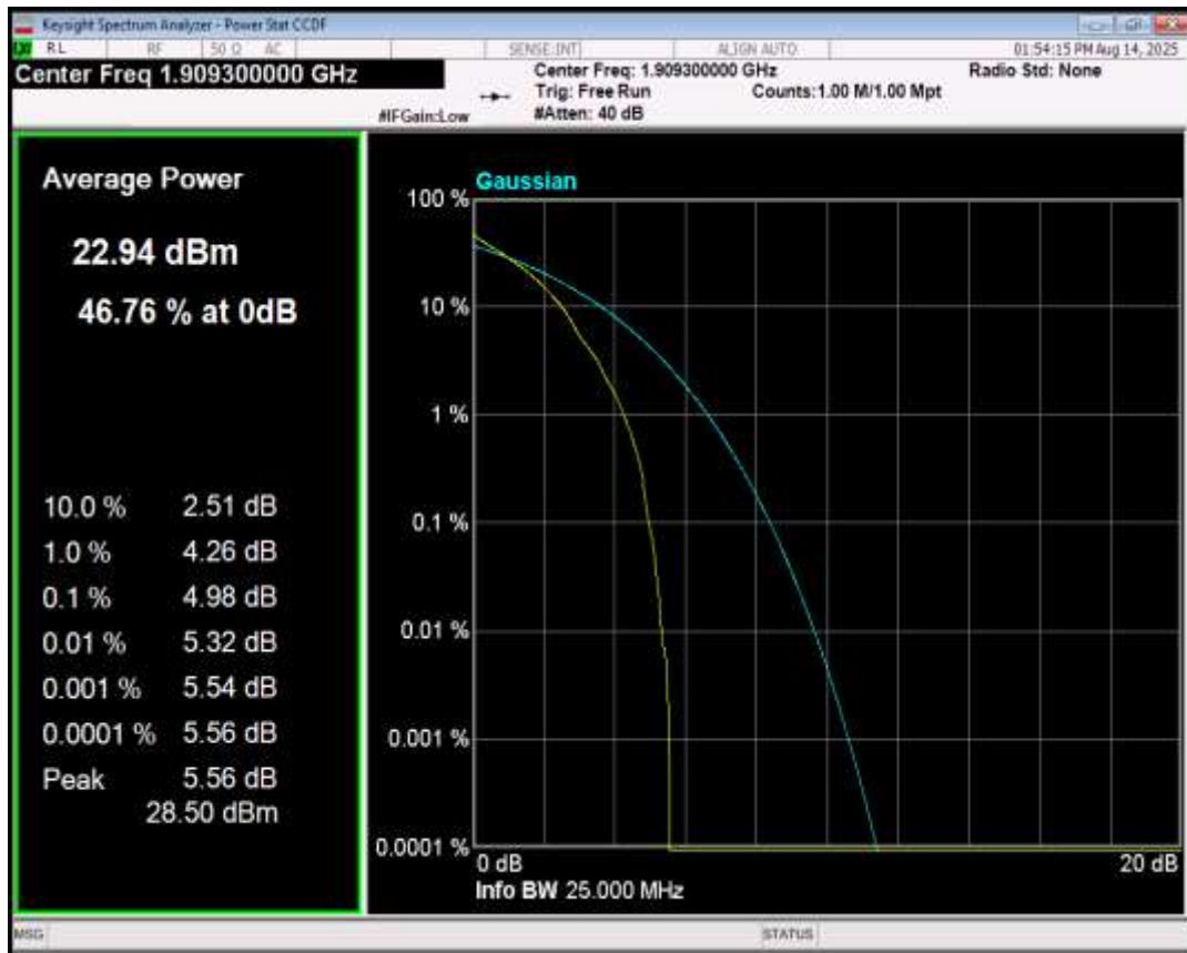
Band2 QPSK BW=10MHz Channel=18650 RB Size=1 Position=#0
