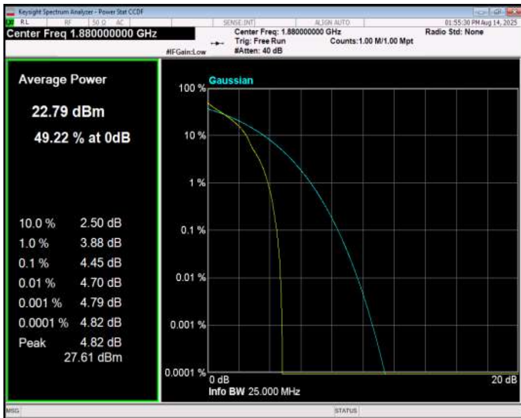
Band2 QPSK BW=15MHz Channel=19125 RB Size=1 Position=#0
