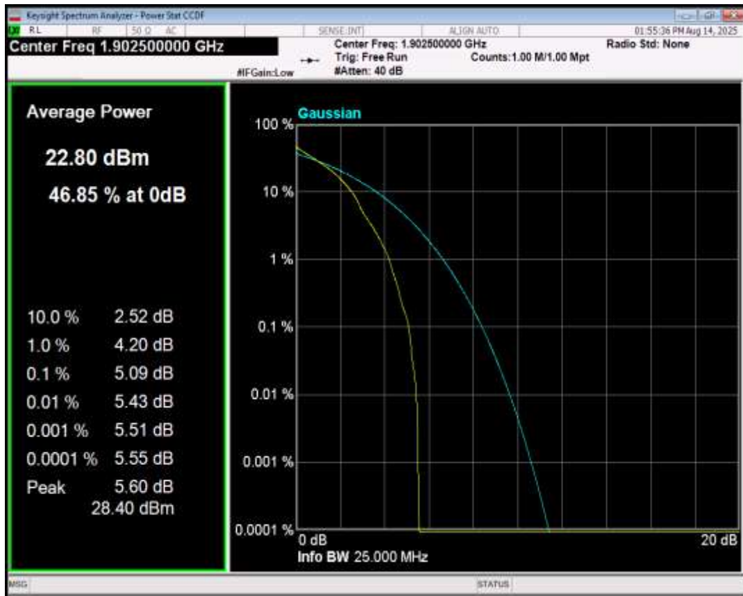
Band2 QPSK BW=20MHz Channel=18700 RB Size=1 Position=#0
