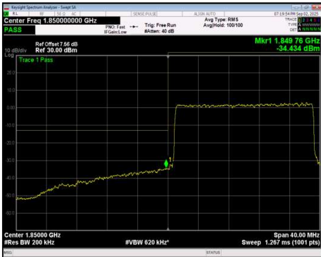
Band2 QPSK BW=20MHz Channel=19100 RB Size=100 Position=#0
