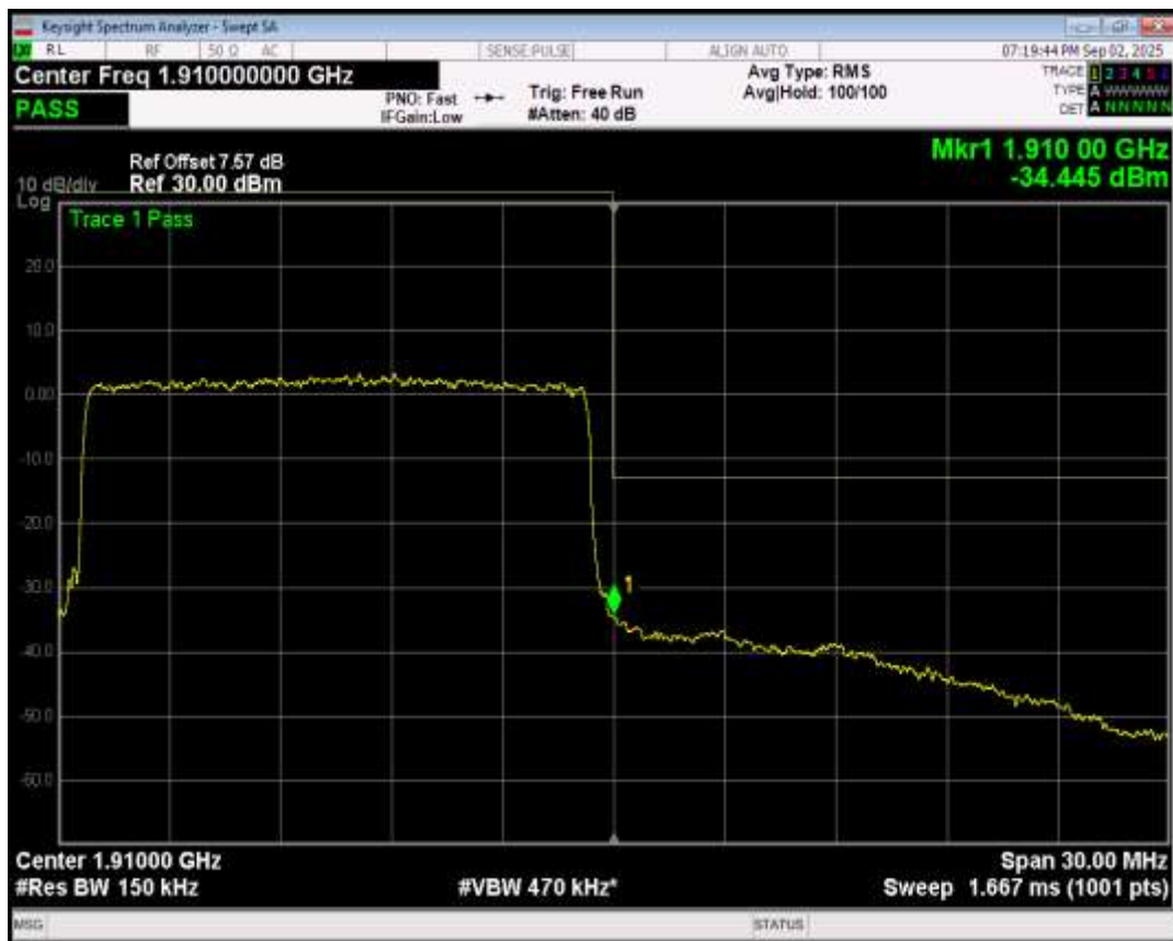
Band2 QPSK BW=20MHz Channel=18700 RB Size=100 Position=#0
