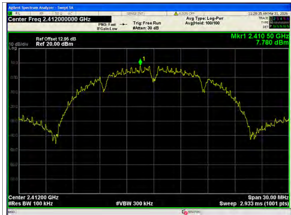
Band Edge NVNT b 2412MHz Ant2 Ref
