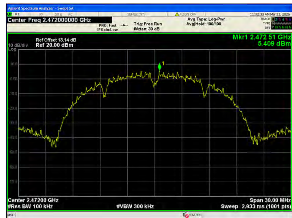
Band Edge NVNT b 2472MHz Ant2 Ref
