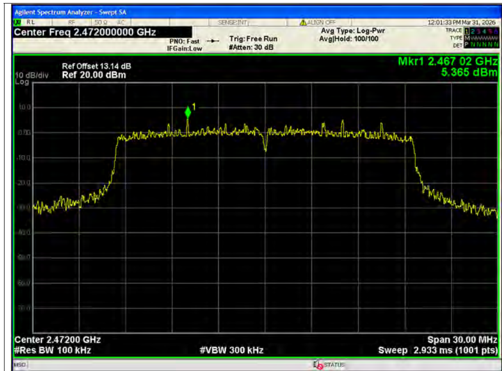
Band Edge NVNT ax20 2472MHz Ant2 Ref
