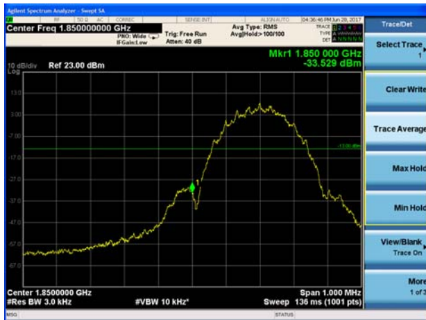
LTE Band 2 1.4MHz QPSK 1RB CH-Low
