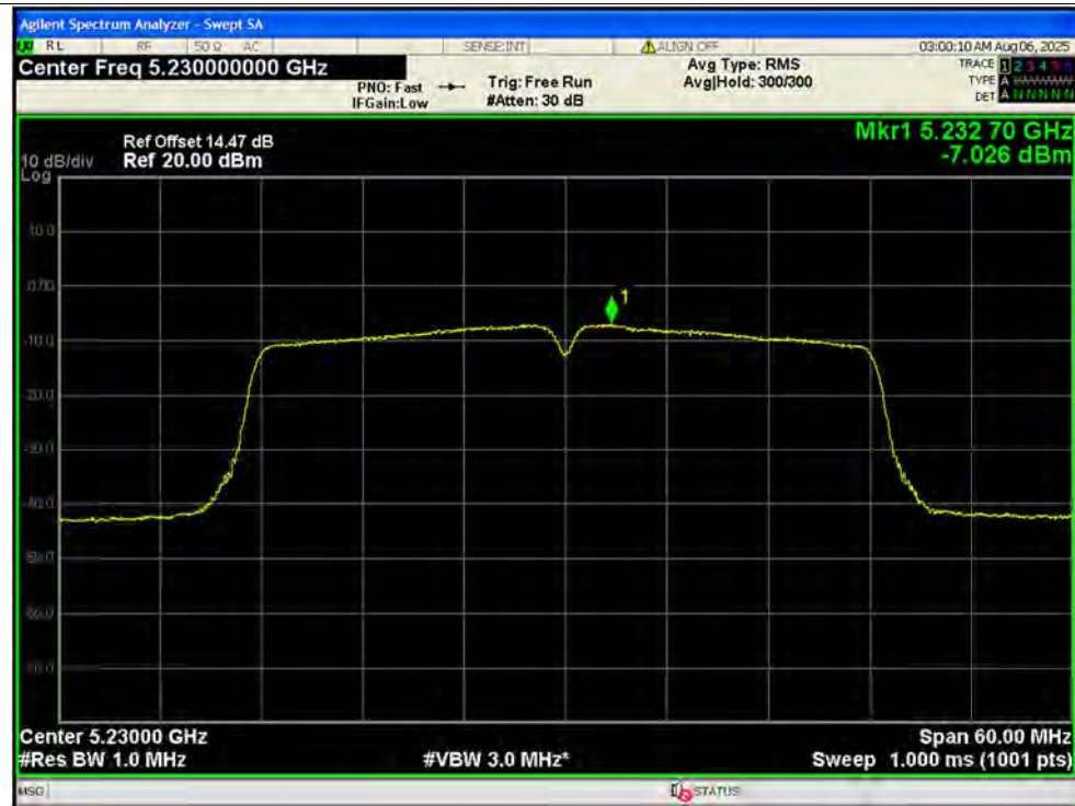
PSD NVNT n40 5230MHz Ant2 MIMO
