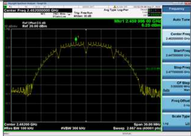
802.11b,2462MHz,Ant1,Plot 3,30MHz~231 0MHz
