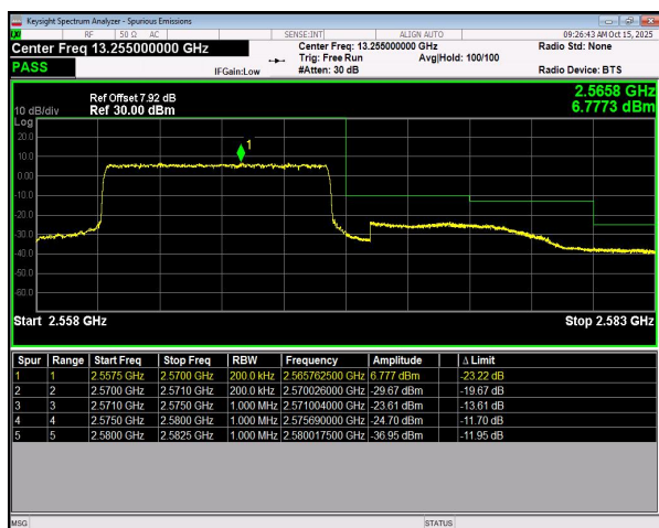
n7 SCS=15kHz DFT_BPSK BW=10MHz HighChannel=513000 RB=50@0
