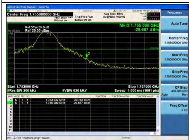
Band4 / 20MHz / High CH / QPSK / 1 RB
