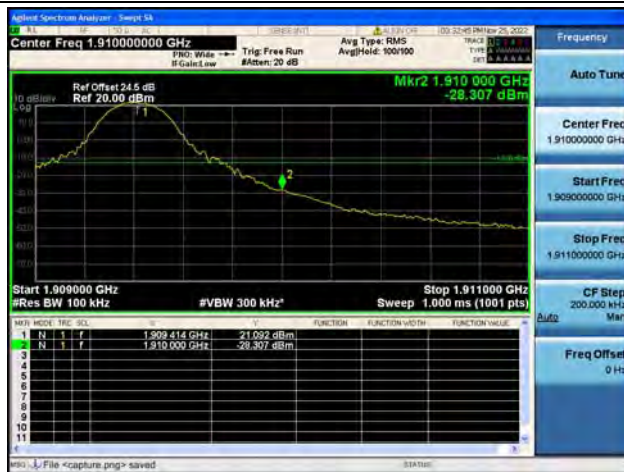
Band2 / 10MHz / High CH / QPSK / 1 RB
