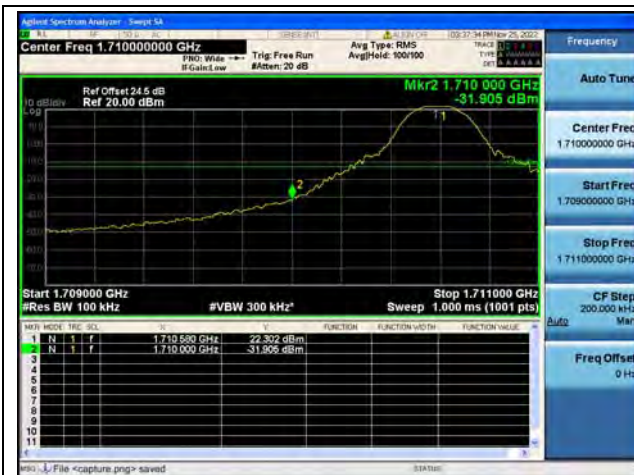
Band4 / 10MHz / Low CH / QPSK / 1 RB
