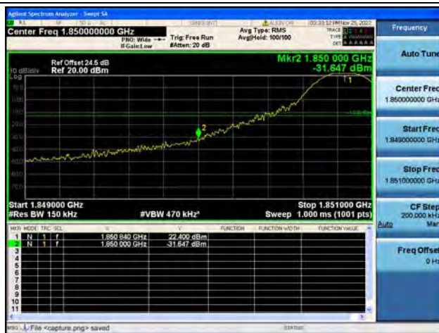
Band2 / 15MHz / Low CH / QPSK / 1 RB
