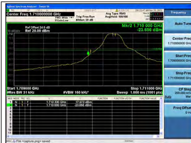
Band66 / 5MHz / Low CH / QPSK / 1 RB
