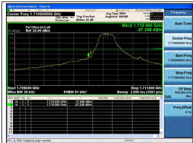
Band4 / 1.4MHz / Low CH / QPSK / 1 RB
