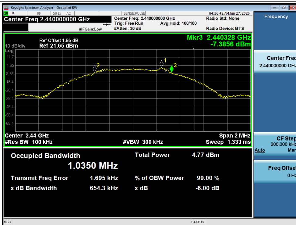
-6dB Bandwidth NVNT BLE 1M 2440MHz Ant1
