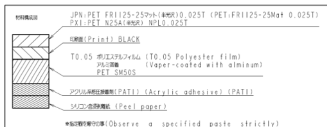
材質構成図 Material composition
