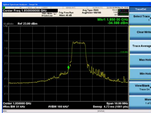
LTE Band 2 5MHz QPSK 1RB CH-Low
