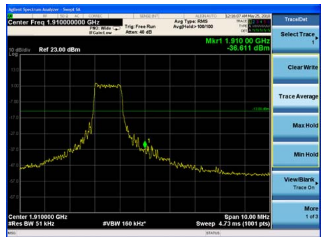
LTE Band 2 20MHz QPSK 1RB CH-High
