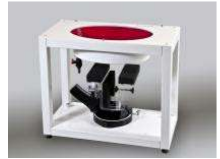
Figure E.5.1 ELI Phantom
