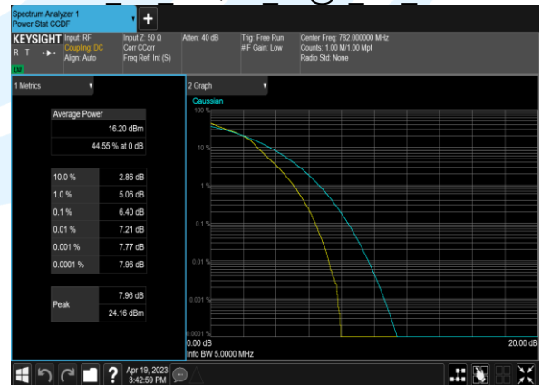
B13 5M 16QAM 25@0 CH 23230
