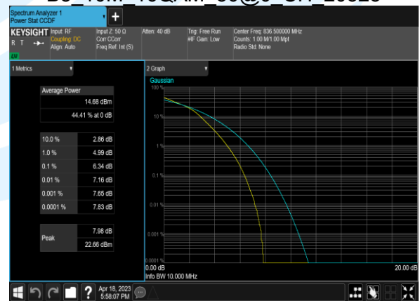
B5 10M 16QAM 50@0 CH 20525
