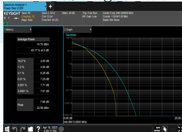
B5 5M 16QAM 25@0 CH 20625
