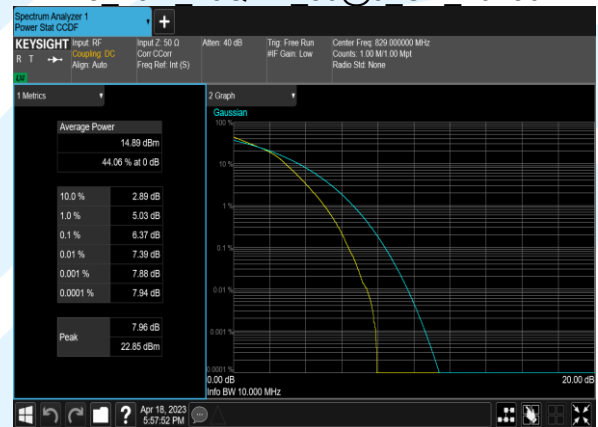
B5 10M 16QAM 50@0 CH 20525
