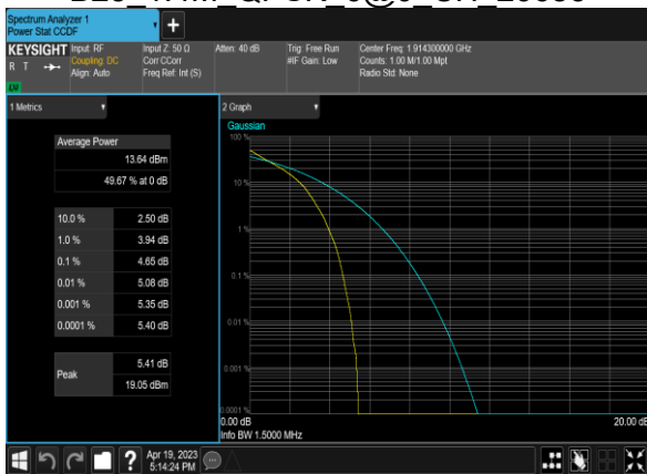
B25 1.4M QPSK 6@0 CH 26683
