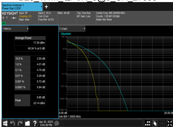
B26 1.4M QPSK 6@0 CH 27033
