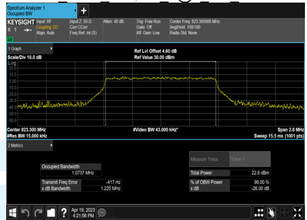
B26 1.4M 16QAM 6@0 CH 26783
