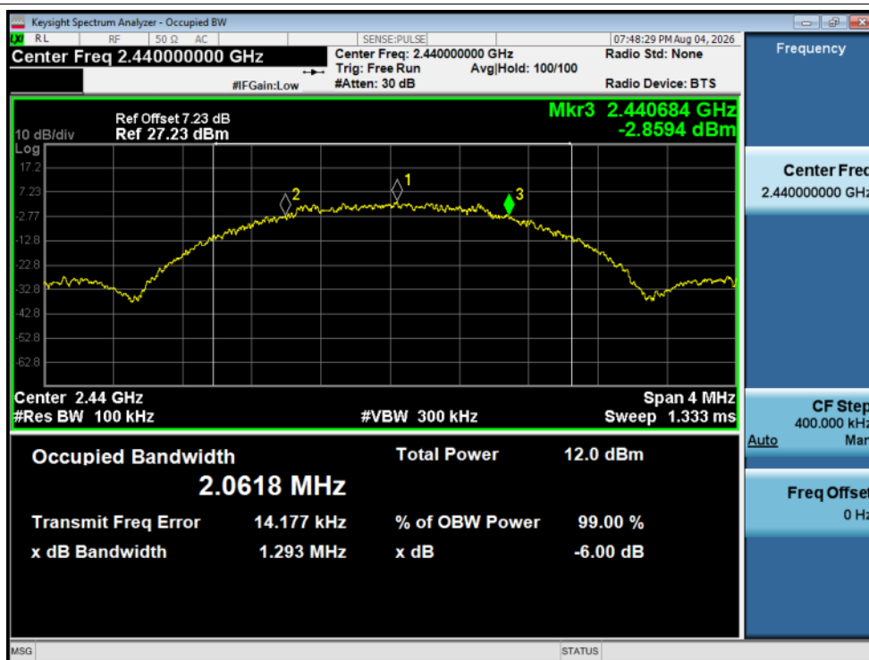
-6dB Bandwidth NVNT BLE 2M 2440MHz Ant1
