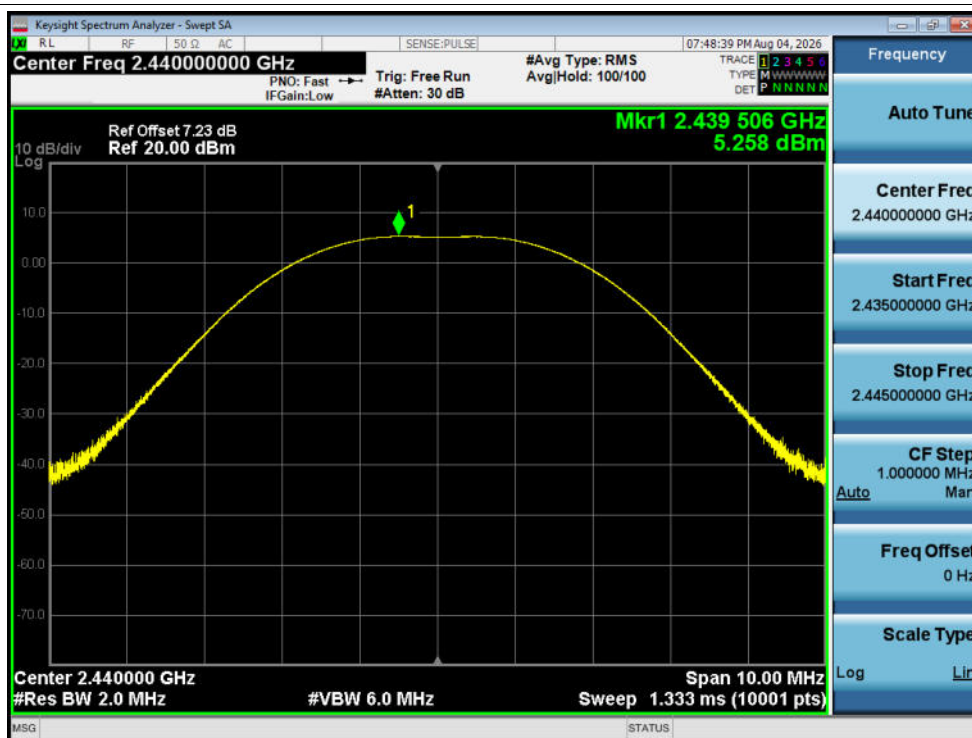
Peak Power NVNT BLE 2M 2440MHz Ant1
