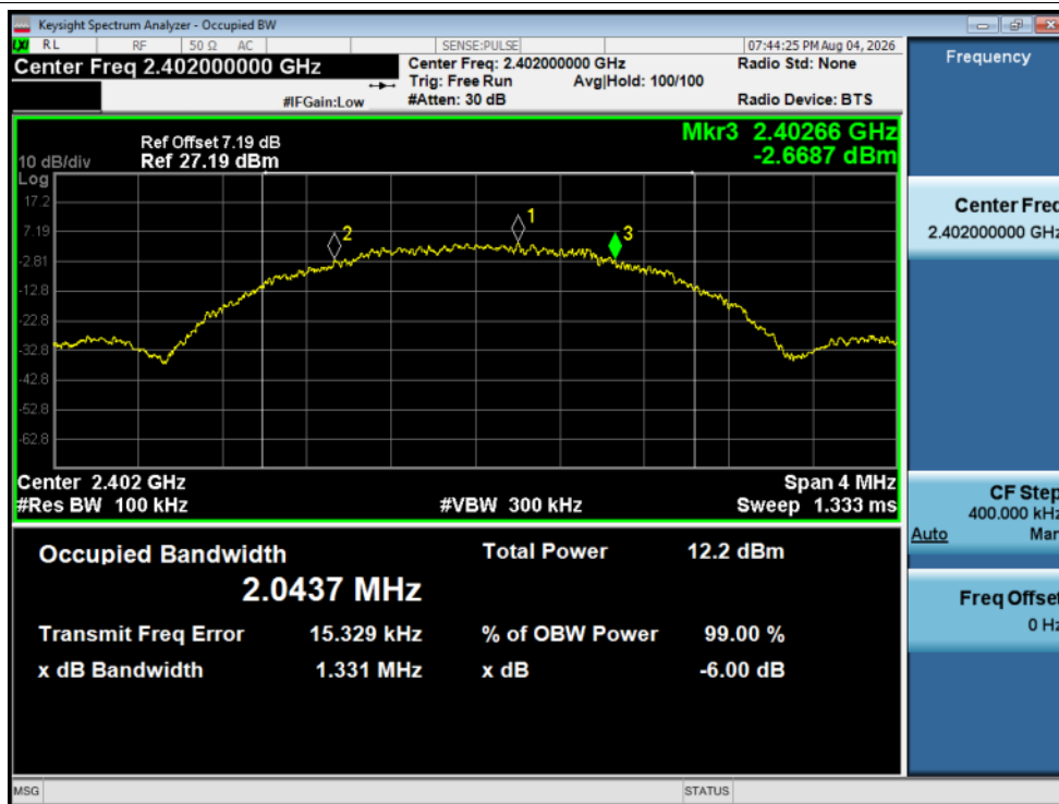
-6dB Bandwidth NVNT BLE 2M 2402MHz Ant1
