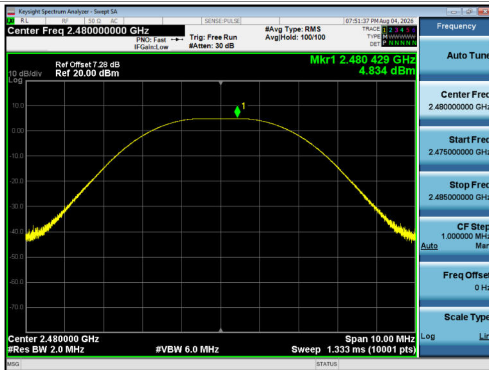
Peak Power NVNT BLE 2M 2480MHz Ant1
