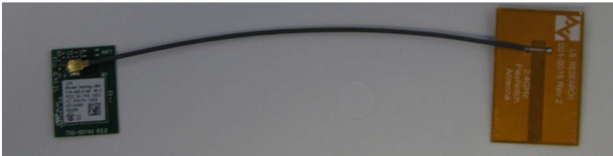
LSR 2.4 GHz FlexNotch Antenna 001-0015
