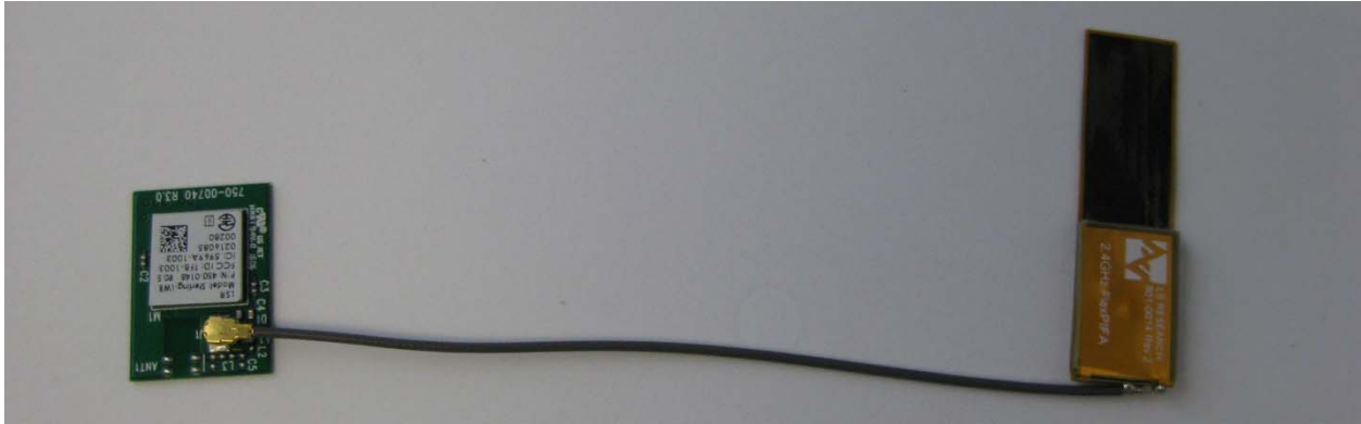
LSR 2.4 GHz FlexPIFA Antenna 001-0014
